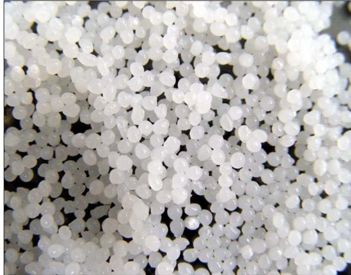
**Figura 29.** Foto das partículas do lote FH05TC, antes do processo de liofilização.
