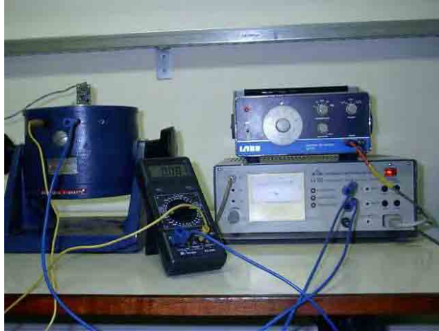
Figura 38 – Bancada de ensaio - gerador de sinais, amplificador e shaker.
