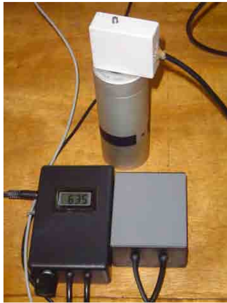
Figura 37 – Bancada de ensaio - monitor com o sensor instalado no excitador.
