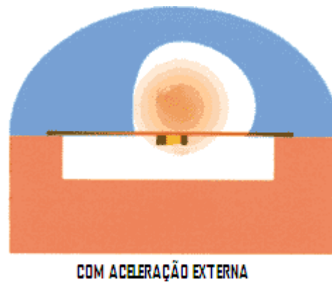
Figura 7 – Acelerômetro MEMS tipo térmico com aceleração externa.
