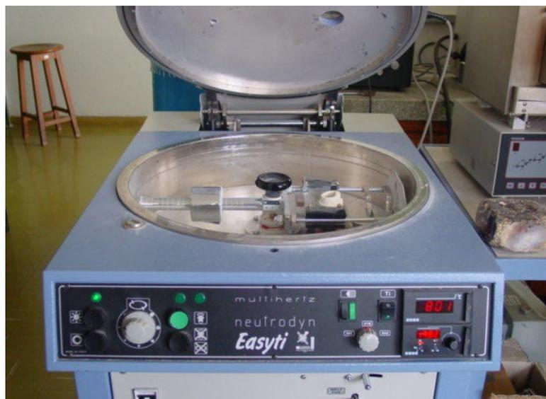
Figura 3.6 - Máquina de fundição por centrifugação
