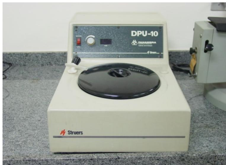
Figura 3.11 -Lixadeira metalográfica utilizada para o acabamento das amostras
