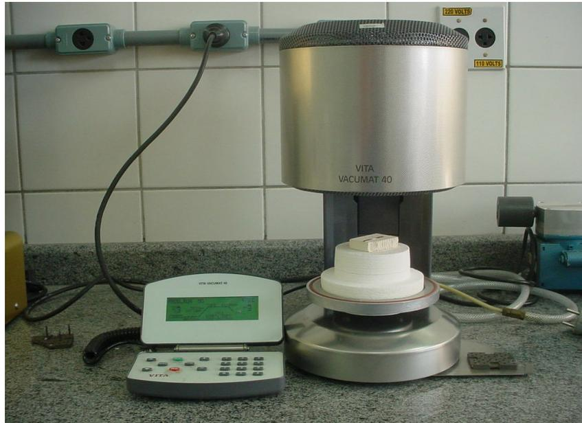
Figura 3.25 - Forno utilizado para aplicação da cerâmica
