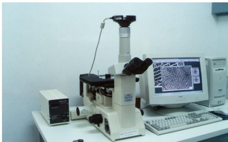
Figura 3.31- Microscópio óptico invertido, metalográfico
