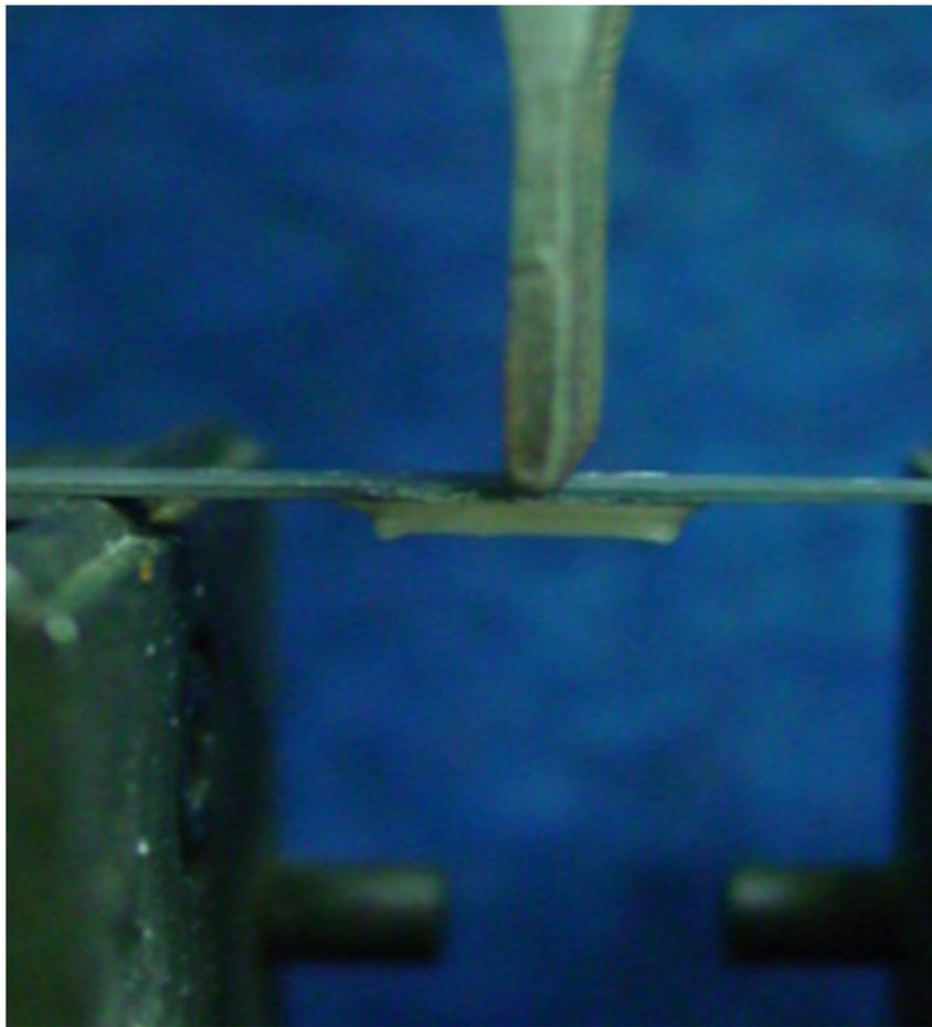
Figura 3.30 – Detalhe da amostra a ser submetida ao ensaio de flexão de três pontos
