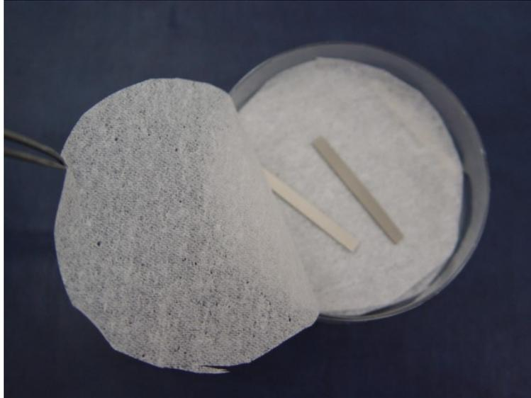
Figura 3.22 – Proteção e armazenamento das amostras após a deposição
