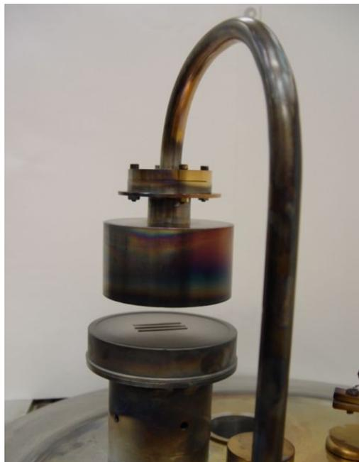
Figura 3.19 – Amostras posicionadas no equipamento para deposição de filmes finos por pulverização catódica (d.c. sputtering)
