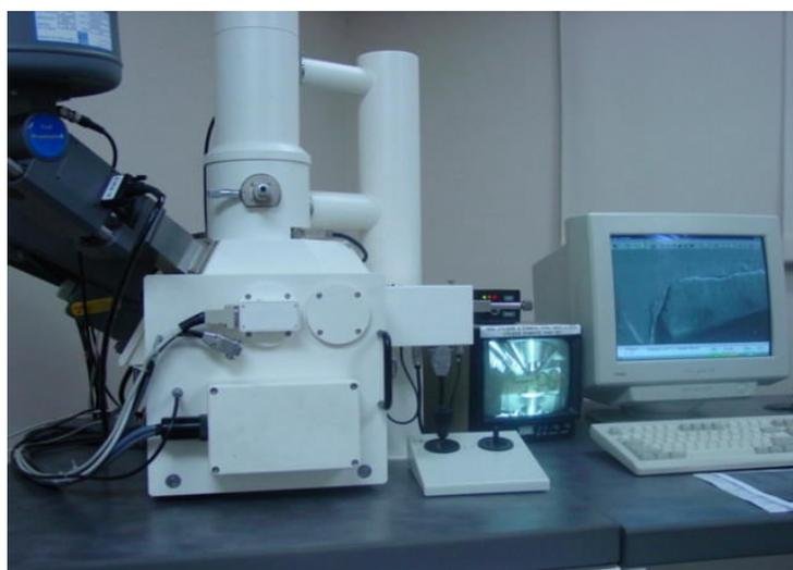
Figura 3.32 - Microscópio eletrônico de varredura utilizado para análise da interface metal-cerâmica
