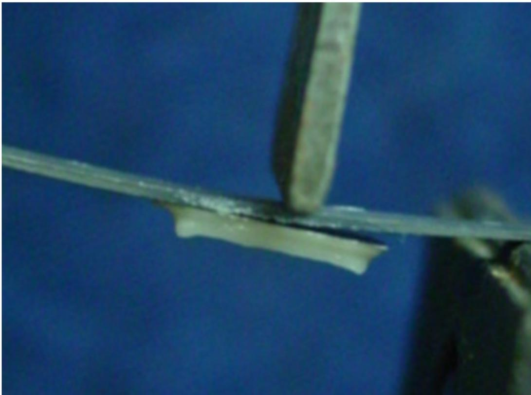
Figura 4.1 – Deslocamento da cerâmica durante a realização do ensaio
