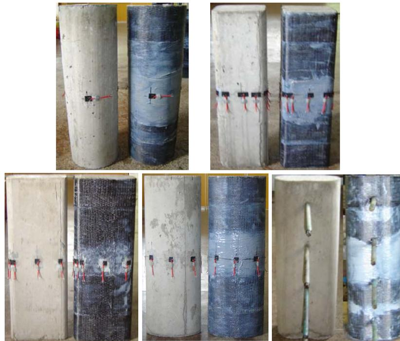
Figura 48: Foto dos modelos prontos para serem ensaiados.
