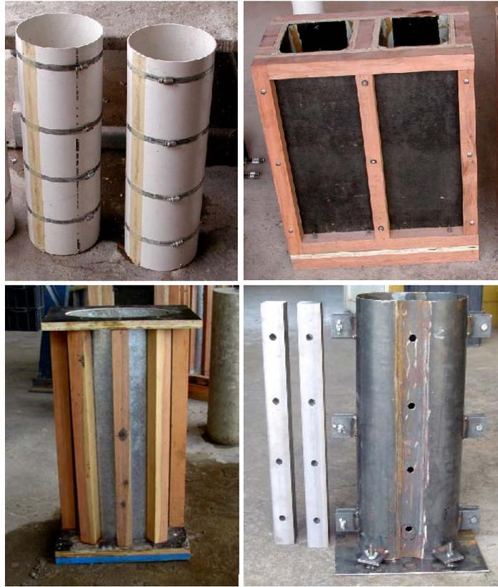
*Figura 41: Foto das fôrmas dos modelos*
