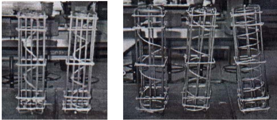
Figura 17: Armaduras utilizadas por ESSAWY & HAWARY (1998).
