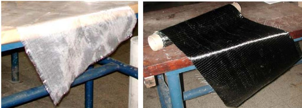
*Figura 42: Foto dos tecidos de fibra de vidro e carbono, respectivamente.*
