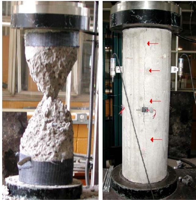
*Figura 52: Ruptura característica e ocorrida com o modelo Ci 02.*
