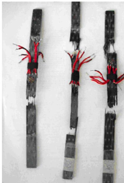
Figura 47: Corpos-de-prova da série CPn-0° após o ensaio.
