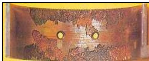
Figura 2.12 – Bronzina danificada por corrosão (MAHLE, 2003).
