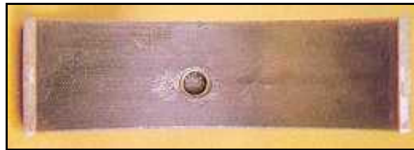
Figura 2.10 – Erosão por cavitação (regiões claras na superfície) em uma bronzina automotiva. (MAHLE, 2003).
