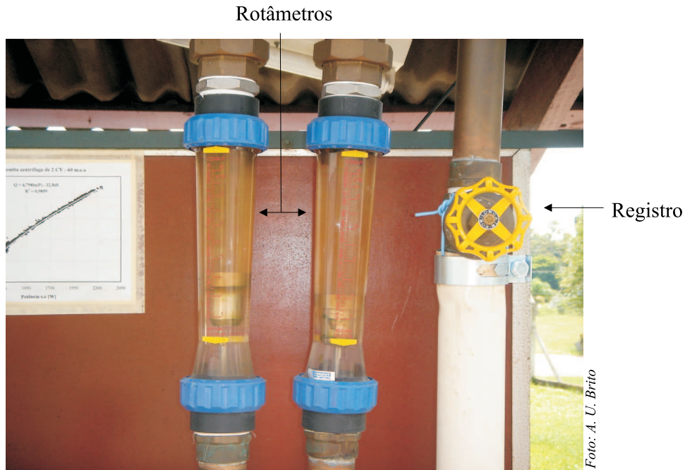
Figura 3.7: Detalhes da bancada de ensaio - rotômetros e registro.
