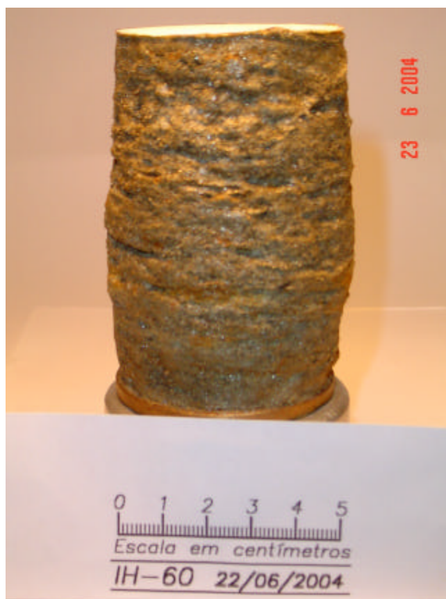
Figura 4-5: corpo de prova IH-60 após o ensaio.
