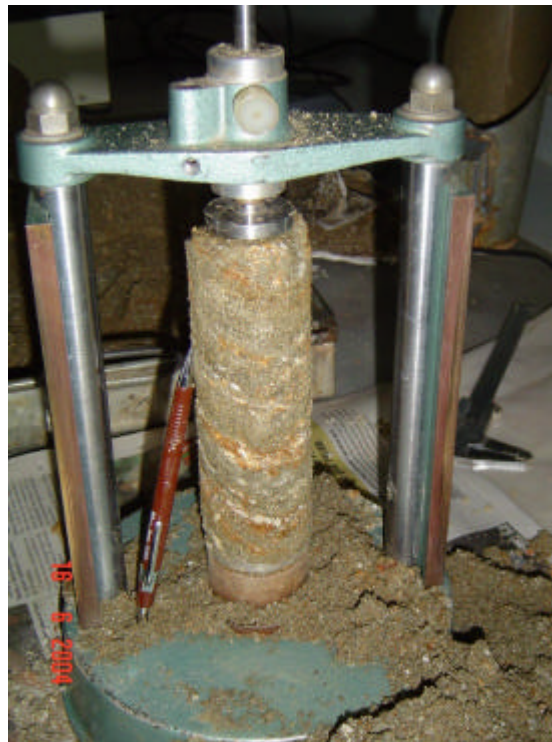
Figura 3-3: Fotografia de um corpo de prova sendo talhado, segundo orientação do bandamento de campo (note a estrutura presente no solo residual de gnaiss).
