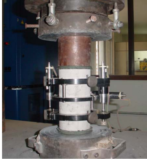
Figura 4.3 - Ensaio de módulo de elasticidade, realizado com o auxílio de dois transdutores tipo LVDT.
