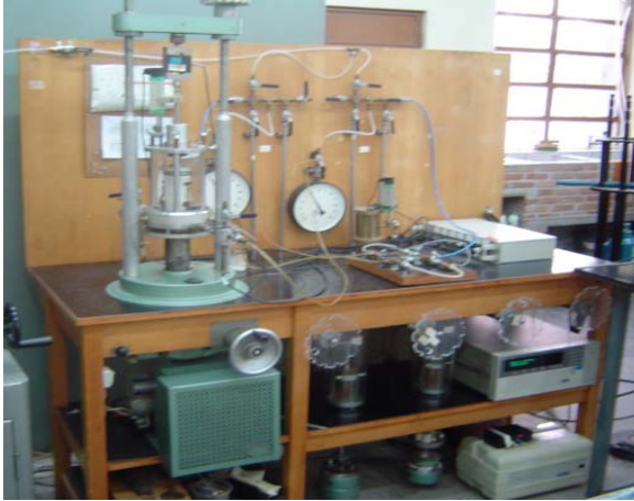
(a) (b) Figura 5.3: prensa triaxial e sistema de aquisição de dados
