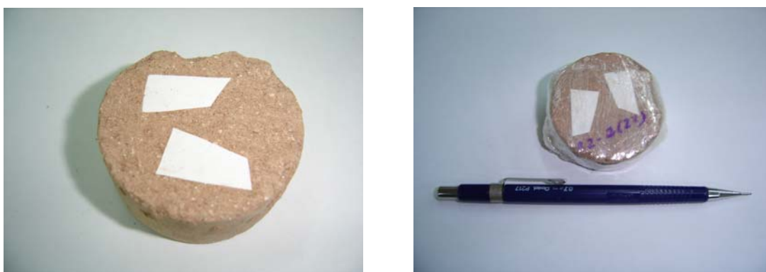
(a) (b) Figura 5.6: corpo-de-prova para ensaio de sucção matricial
