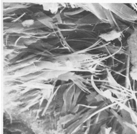
Figura 7.1: fotomicrografia da pasta de cimento Portland endurecida (INGLES & METCALF, 1972)
