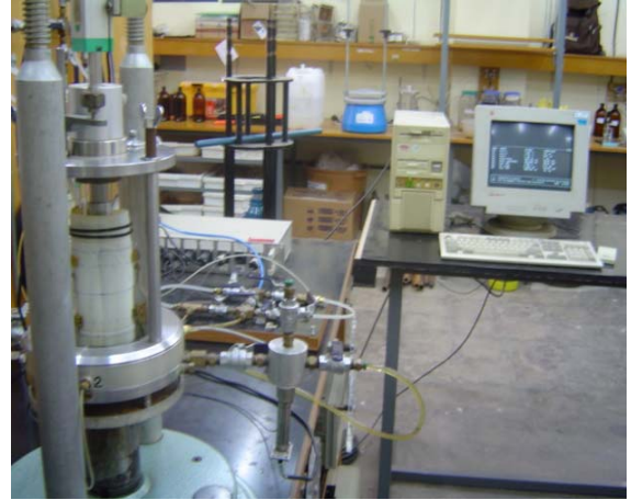
(a) (b) Figura 5.3: prensa triaxial e sistema de aquisição de dados
