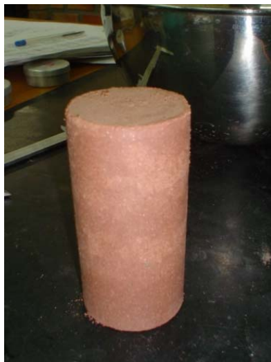
Figura 5.1: corpo-de-prova de solo-cimento
