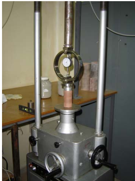
Figura 5.2: ensaio de resistência à compressão simples
