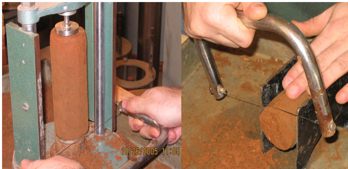
Figura 4.4 –Moldagem dos corpos de prova indeformados.
