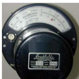
B – Detalhe da escala do viscosímetro Brookfield LVT
