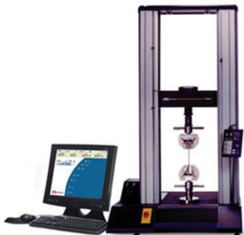
Figura 28 – Dinamômetro usado para determinação das propriedades mecânicas
