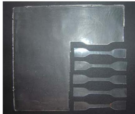
Figura 21 – Filme pronto para determinação das propriedades (corpos de prova)
