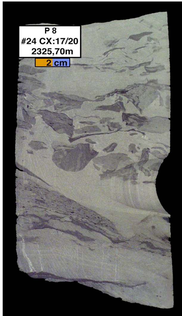
Figura 31. Fácies D5. Arenito conglomerático, apresentando seixos de lamito intraformacional com incipiente orientação.
