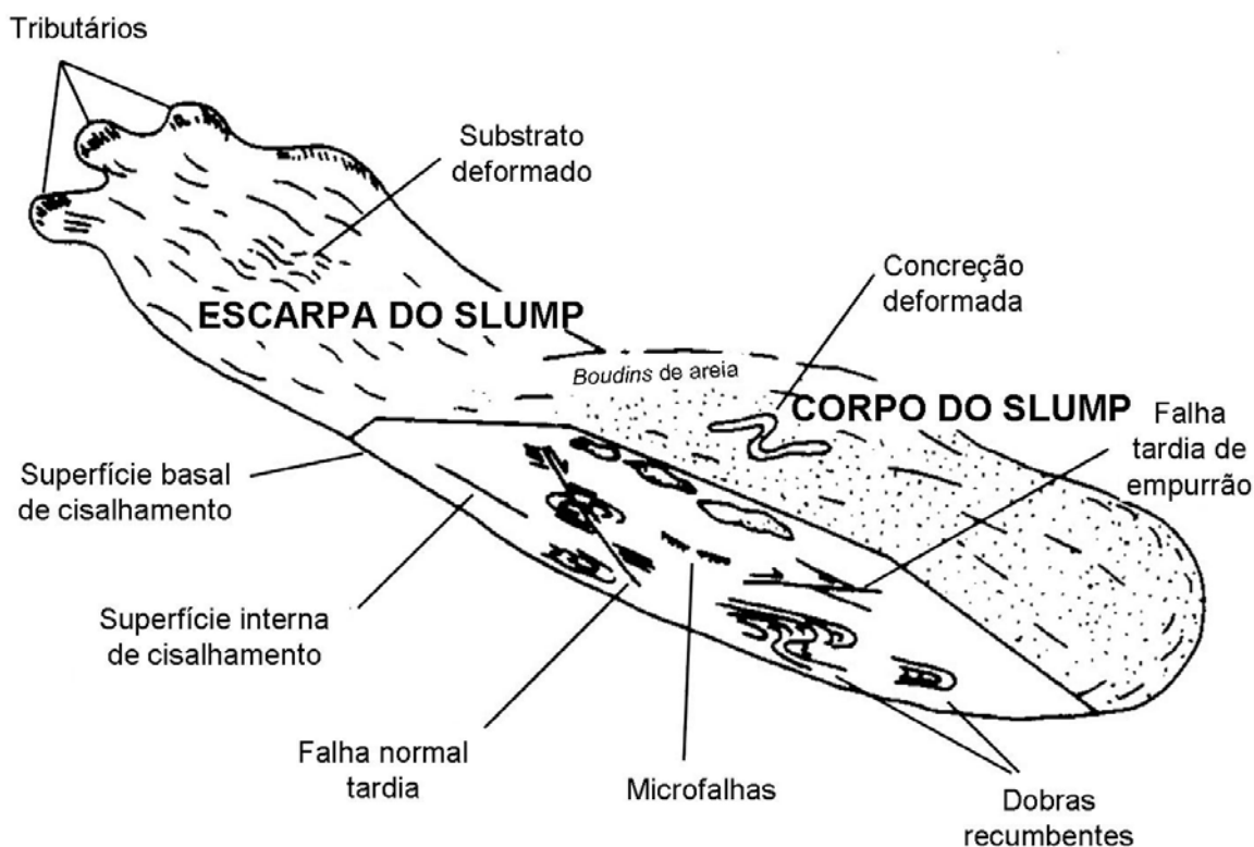
Figura 10. Representação esquemática de um corpo de escorregamento ( slump ). Observar a zona da escarpa proximal e a zona distal, mais deformada. Modificada de Stow et al. (1996).
