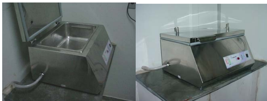
FIGURA 5 Cuba ultra-sônica em aço inoxidável, adaptada com saídas de água e degasagem. Cortesia White Martins Gases Industriais e Universidade de Alfenas, Alfenas, 2005.
