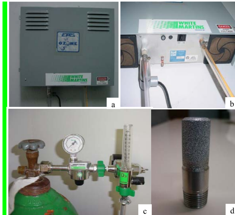
FIGURA 4 Gerador de ozônio (a, b), cilindro de oxigênio com reguladores de pressão, manômetros e fluxômetro (c); difusor sinterizado (d). Cortesia White Martins Gases Industriais, Alfenas, 2005.
