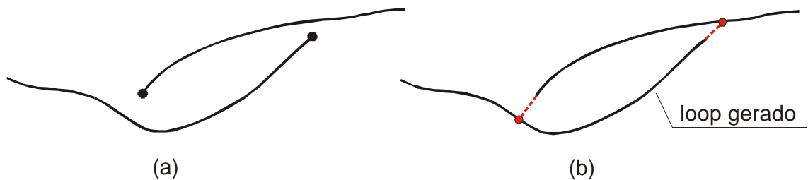
Figura 4.5 - Situação possível de alguns elementos lineares antes (a) e após a aplicação da rotina ExtLinhasFlut (b) e o loop gerado.
