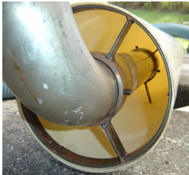
Figura 30 – Ejetor centralizado no tubo de PVC para ensaio.
