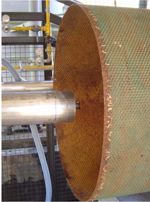
Figura 78 – Montagem externa para determinação dos harmônicos do tubo.
