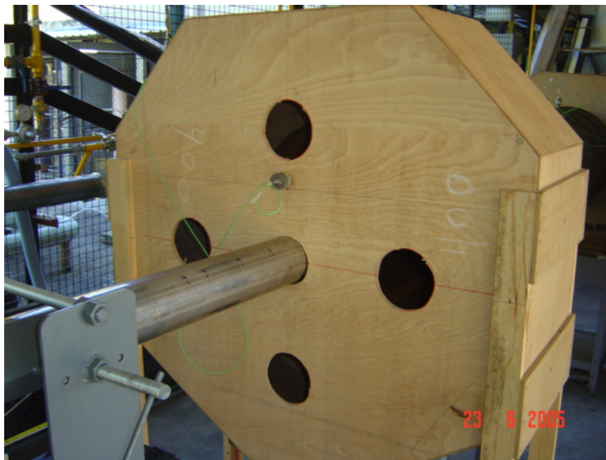
Figura 93 - Caixa de entrada do modelo com furos para entrada de ar.
