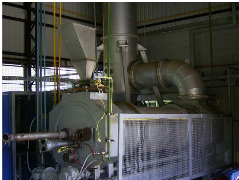
Figura 7 – Conjunto forno rotativo – câmara secundária. Forno rotativo já refratado, com queimador de GLP e alimentador de resíduos acoplados.
