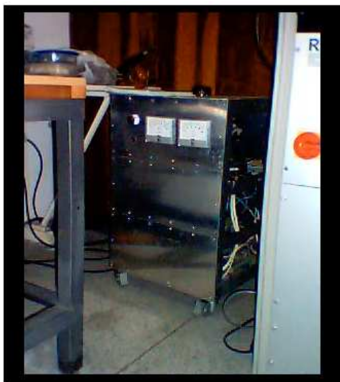
Figura 45 – Fotografia mostrando a fonte de tensão contínua DC com capacidade para até 2000V.
