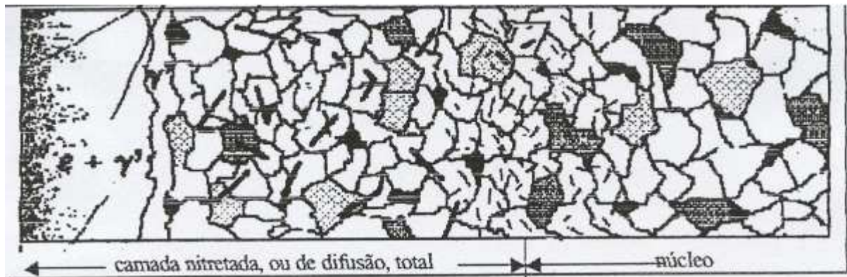
Figura 7 – Esquema das fases presentes na camada branca e de difusão, (LILIENTAL, W. K.; TYMOWSKI, N. T., 1999).
