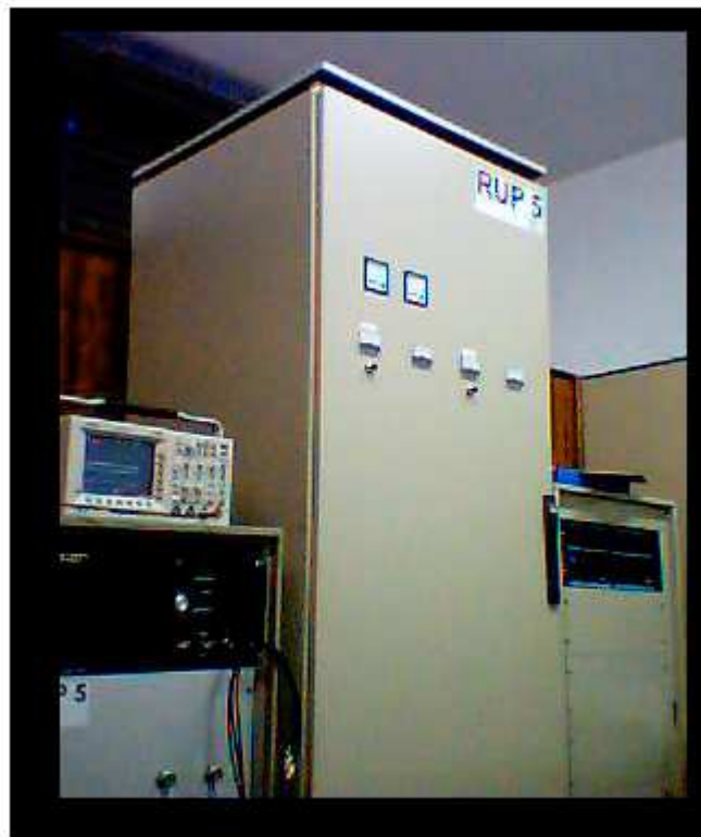
Figura 43 – Fotografia mostrando o pulsador com capacidade para até 50kV negativos e frequência de 3 kHz.
