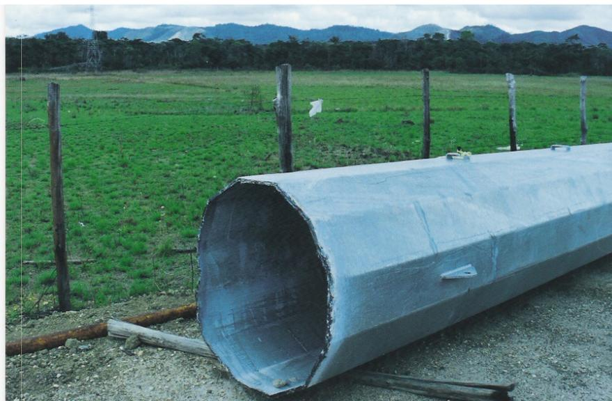
**Figura 25 - Foto de Torre Tubular Derrubada**
