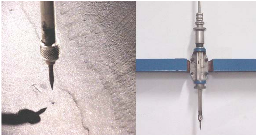
Figura 36 - Detalhe da ponta linimétrica.
