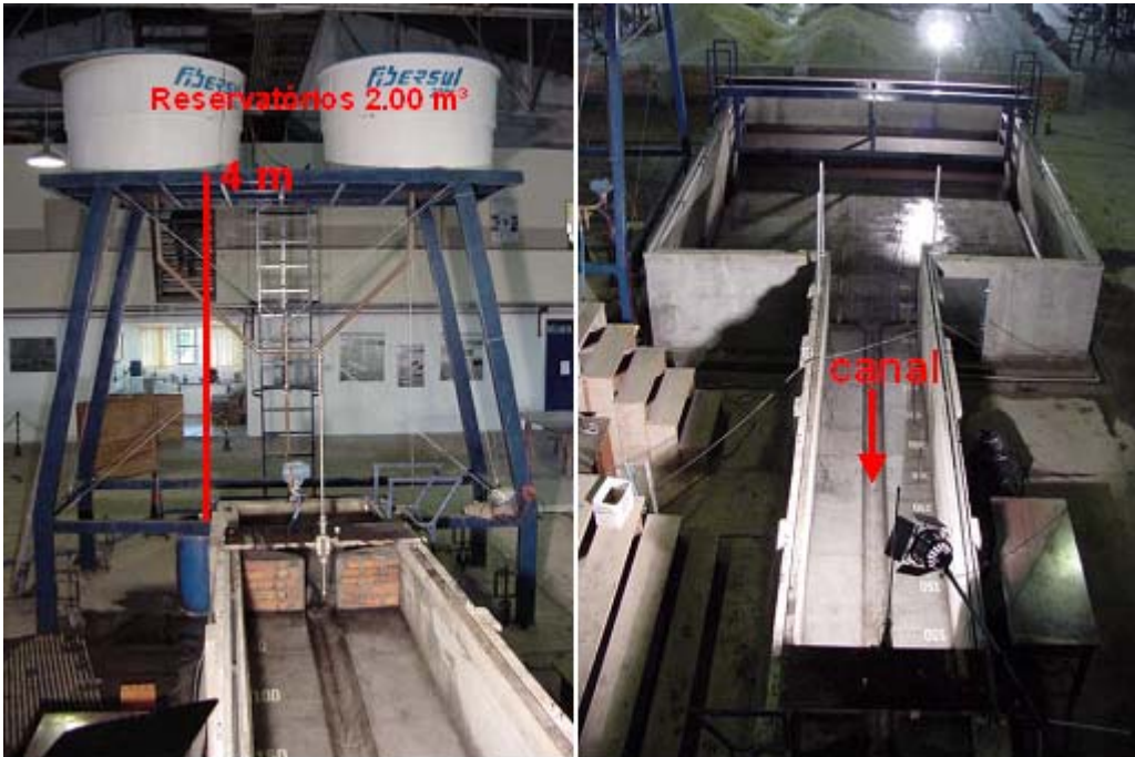
Figura 30 Figura 4.3 – Fotografias das instalações utilizadas. A esquerda detalhe dos reservatórios onde foram realizadas as misturas de carvão com água, as instalações hidráulicas e o sistema de medição e coleta de amostras. A direita detalhe do tanque onde foram realizados os ensaios.
