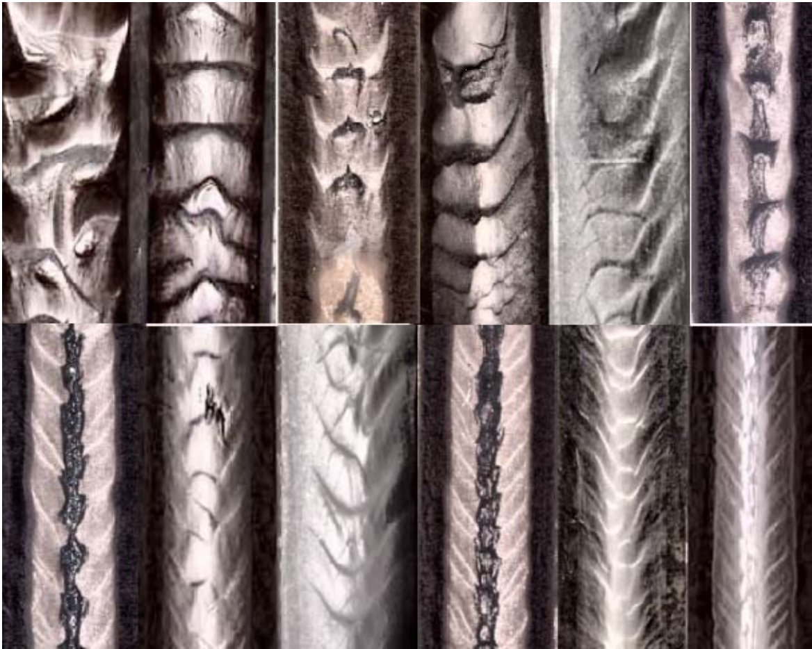
Figura 157– Seqüência ideal de formas de leito constatadas nos ensaios da esquerda para direita, inicialmente na linha superior passando a linha inferior. São elas ripples lineares que progressivamente vão se deformando até se tornarem com crista sinuosa, no sentido do fluxo passam a assumir a forma lingüóide diminuindo tanto a distância entre as cristas como a amplitude.
