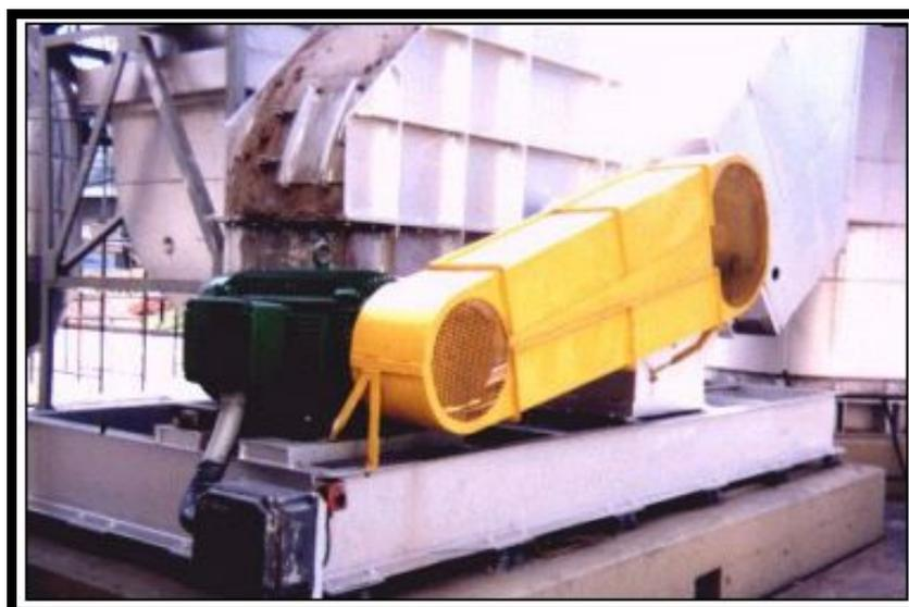
Figura 5.17. Motor Alto Rendimento 75 cv
