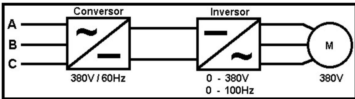
Figura 3.15. Esquema básico de um conversor de frequência (MAMEDE, 1997)
