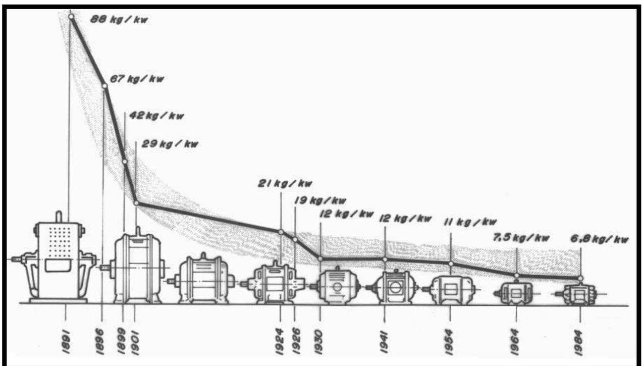
Figura 3.2. Evolução dos motores elétricos (ELETROBRÁS, 2003)
