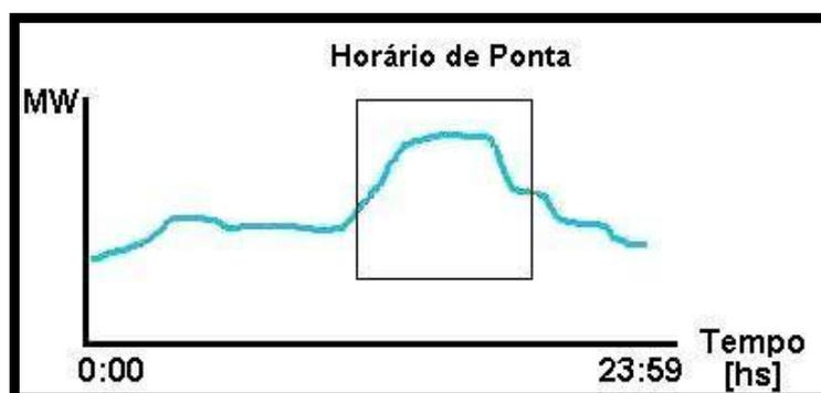
Figura 6.1. Curva de carga diária do sistema elétrico (ELETROBRÁS, 2003)
