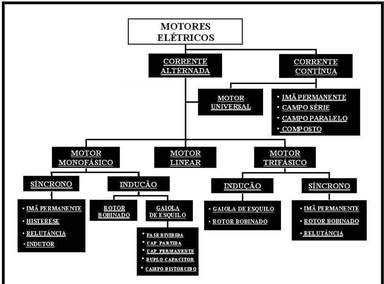
Figura 3.3. Classificação dos motores elétricos (MAMEDE, 1997)
