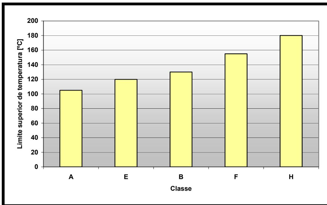
Figura 3.18. Classes de temperatura (NBR 7094, 1996)
