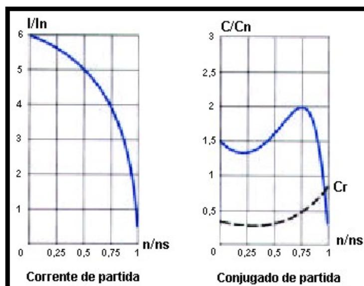
Figura 3.10. Corrente e conjugado de partida em relação à rotação do motor (WORKSHOP..., 2004)
