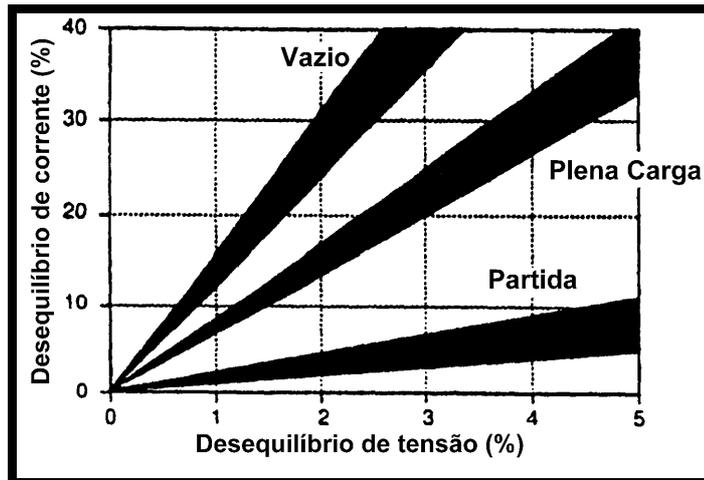
**Figura 3.19. Desequilíbrio de corrente em função do desequilíbrio de tensão**
