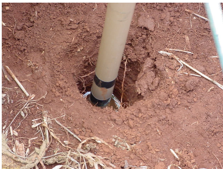
Figura 5 - Permeâmetro de Guelph
