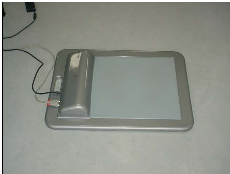
Figura 05: Plataforma de força com sensor piezoelétrico de quartzo de 90 x 75 cm, marca Midicaptours, modelo Twin 99 versão 2.08 (França).
