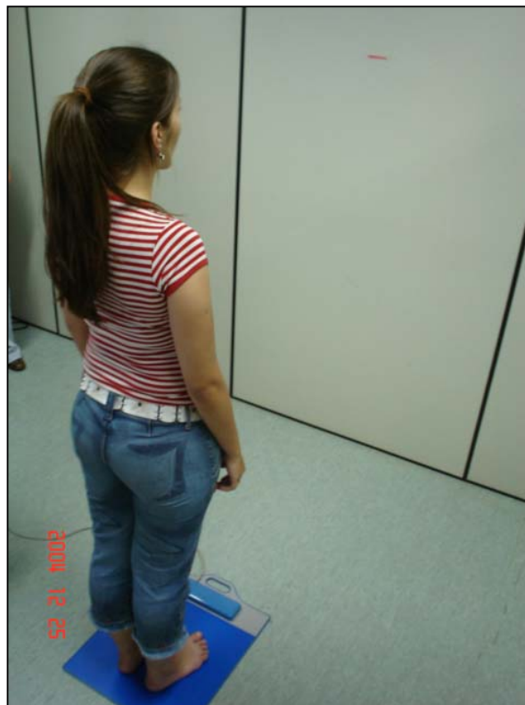
Figura 07: Representação do indivíduo sob a plataforma de estabilometria mantendo os pés paralelos, olhando para o alvo a uma distância de 1,2 m, com os membros superiores relaxados ao longo do corpo.
