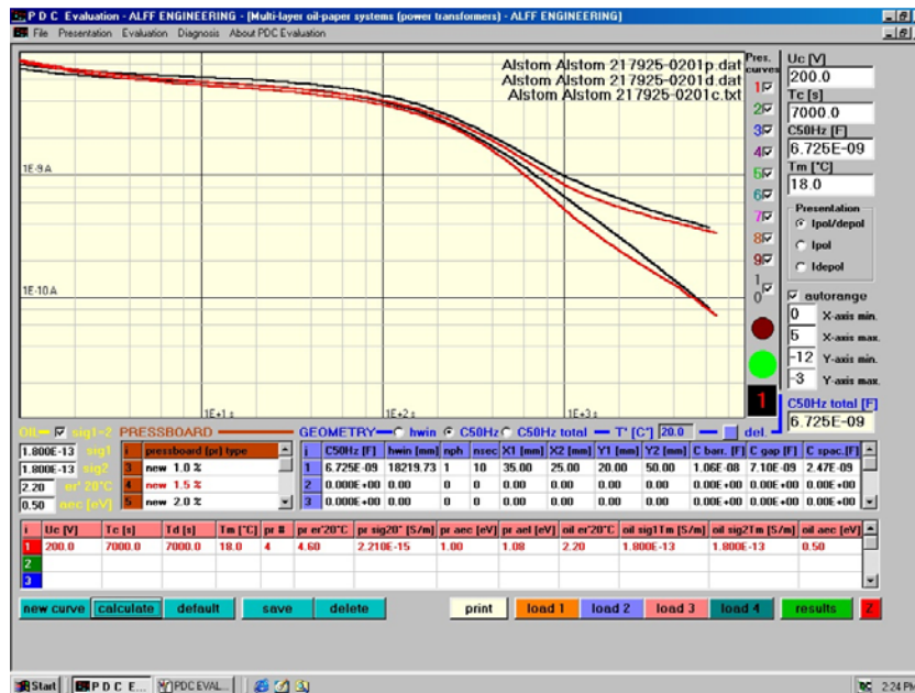
Figura 6.8: Tela do aplicativo de diagnóstico da umidade no papel da isolamento sólida ( PDC Analysing Software ) do módulo off-line do sistema de monitoramento de transformadores.
