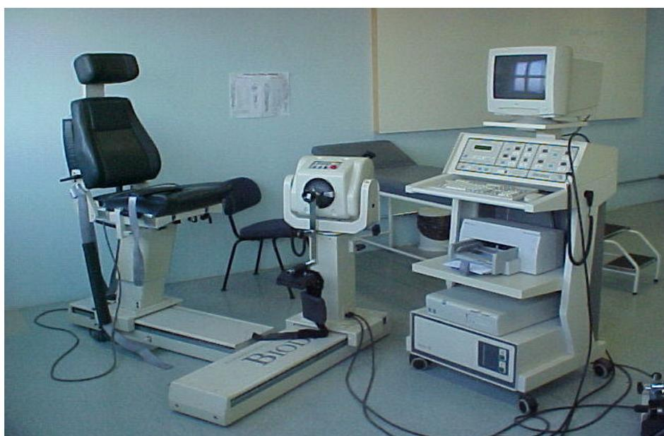
**Figura 2.** Dinamômetro Isocinético Biodex System 3
