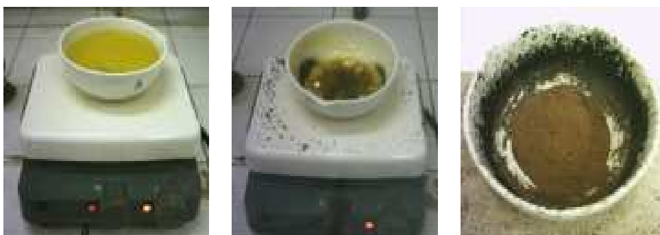
FIGURA 2.1: Principais estágios do processo: (a) solução aquosa, (b) evaporação e (c) pó final
