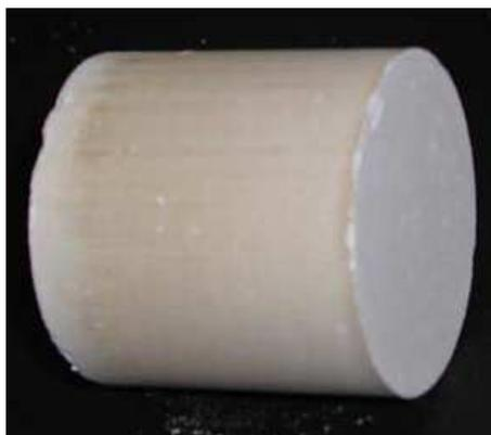
Figura 4.3: Amostra típica de zeólita . Figura retirada de [4]
