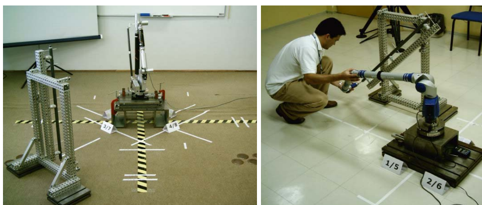
Figura 34 – Definição dos octantes e marcações no piso para a aplicação da ASME B89.4.22-2004. À esquerda uma ilustração com um BAM Romer e à direita com um BAM FARO.
