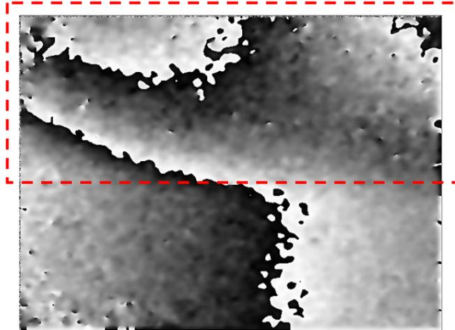
Figura 4.10 – Limite inferior da falha de adesão no duto B.
