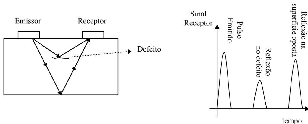
Figura 3.1 – Detecção de defeitos utilizando ultra-som pulsado. [5]
