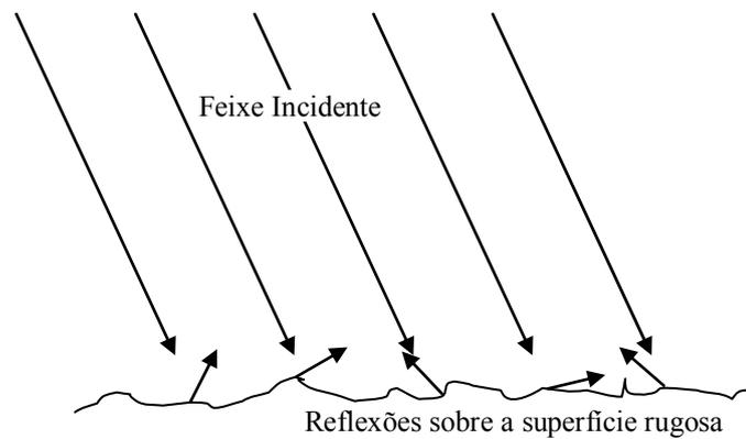
Figura 3.2 – Reflexão de uma luz coerente sobre uma superfície rugosa. [3]
