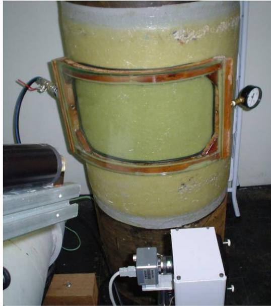
Figura 5.3 – Câmara de vácuo montada sobre o duto C.
