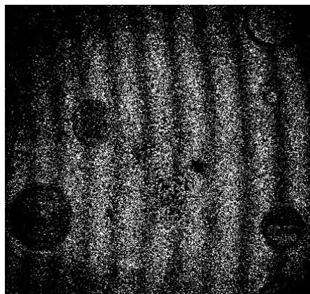
Figura 3.6 – Mapa de franjas obtido com holografia eletrônica.
