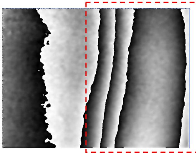
Figura 4.8 – Extremidade esquerda da falha de adesão no duto A.
