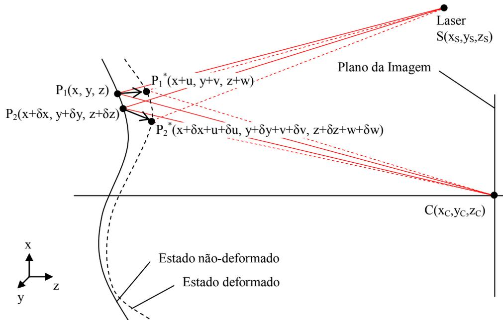
Figura 3.8 – Variação do caminho óptico pela deformação do objeto. [1]
