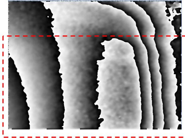
Figura 4.6 – Limite superior da falha de adesão no duto A.
