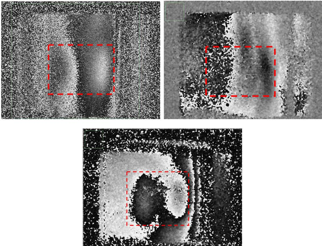
Figura 5.8 – Falha de adesão 1 no duto D. (a) Carregamento mecânico. (b) Carregamento térmico. (c) Carregamento a vácuo.
