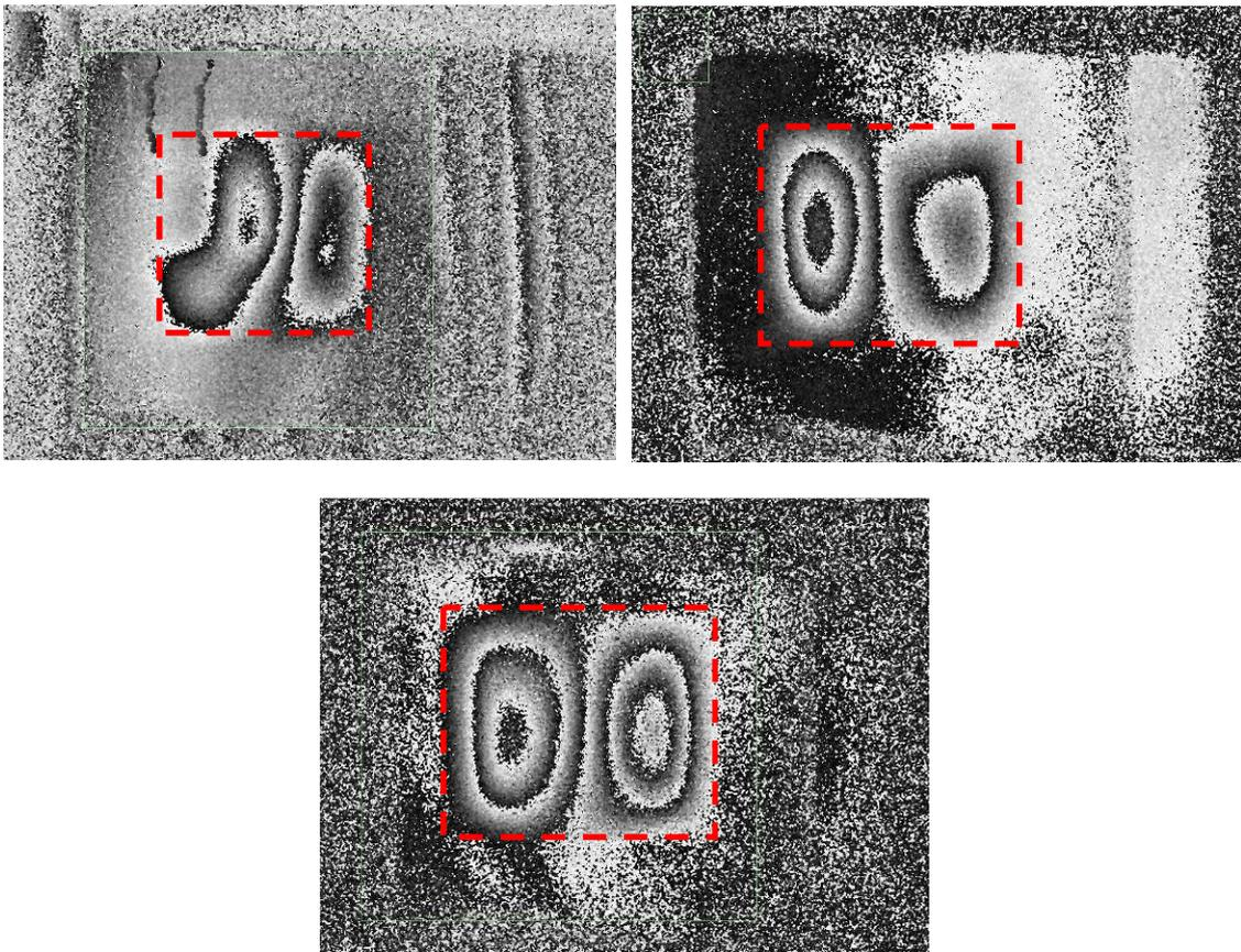
Figura 5.7 – Falha de adesão 2 no duto C. (a) Carregamento mecânico. (b) Carregamento térmico. (c) Carregamento a vácuo.
