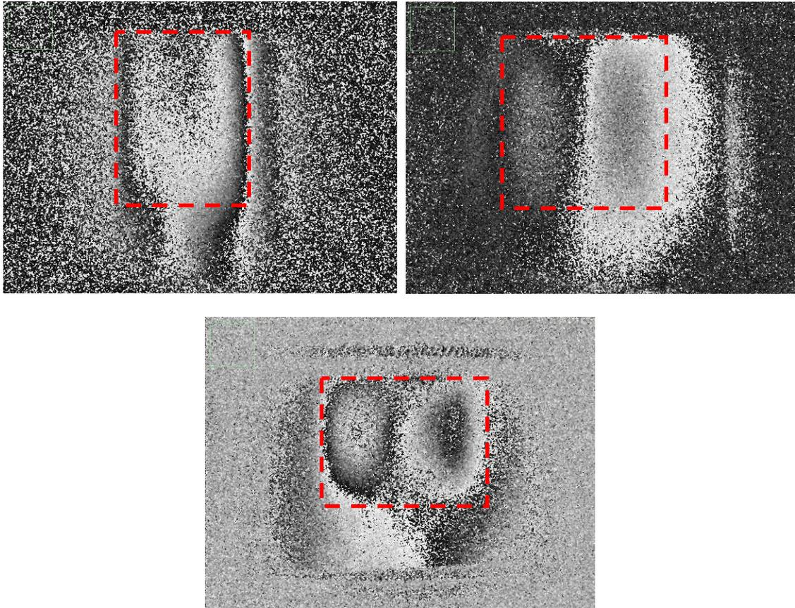
Figura 5.11 – Falha de adesão 4 no duto D. (a) Carregamento mecânico. (b) Carregamento térmico. (c) Carregamento a vácuo.
