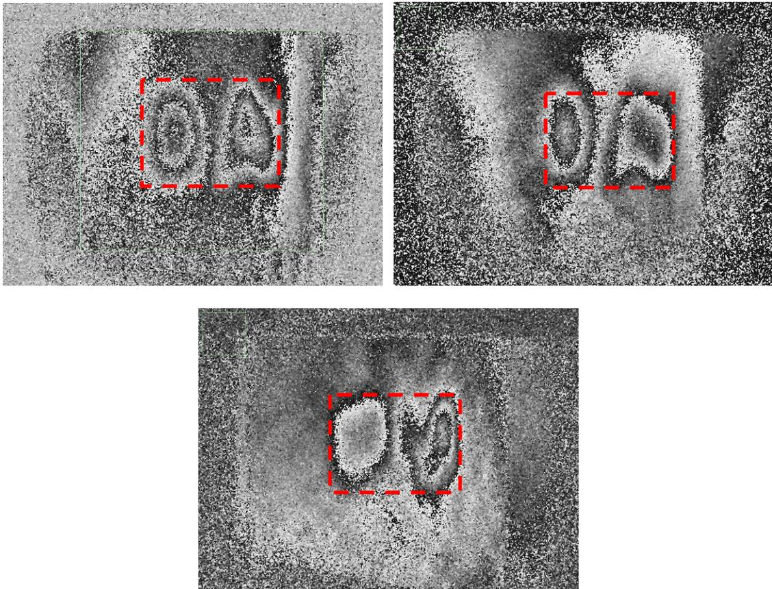
Figura 5.10 – Falha de adesão 3 no duto D. (a) Carregamento mecânico. (b) Carregamento térmico. (c) Carregamento a vácuo.
