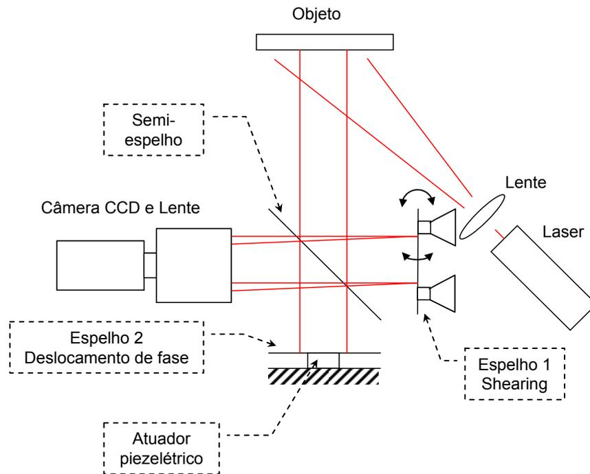
Figura 3.10 – Interferômetro de *Michelson* modificado para geração do *shearing* e deslocamento de fase.
