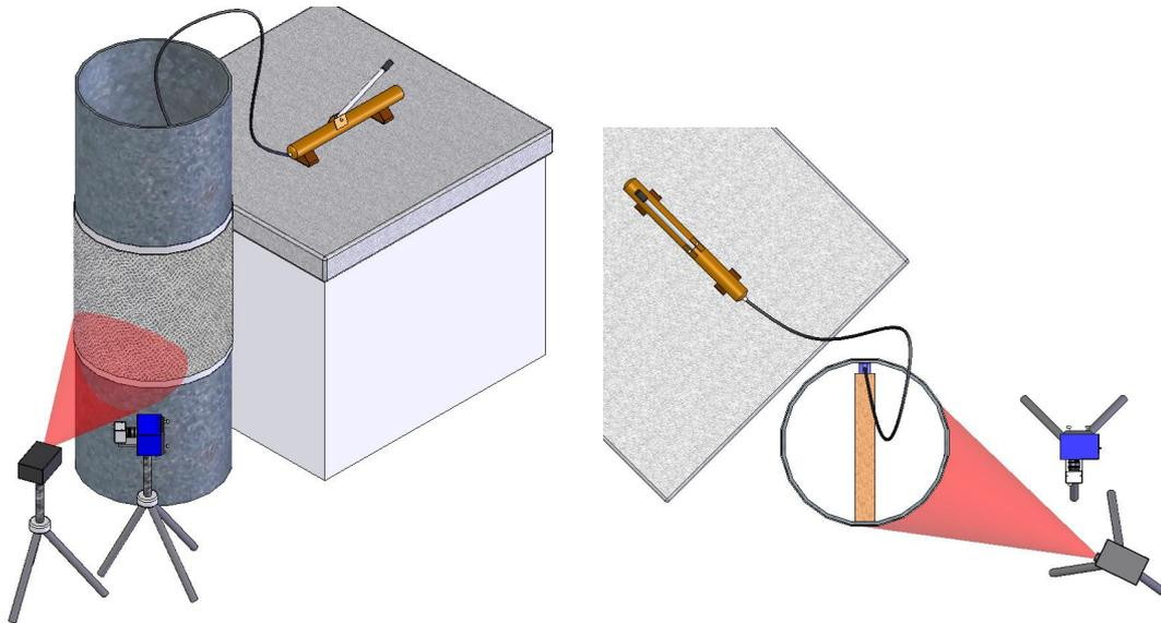
Figura 5.2 – Configuração montada para aplicação de carga por força interna.
