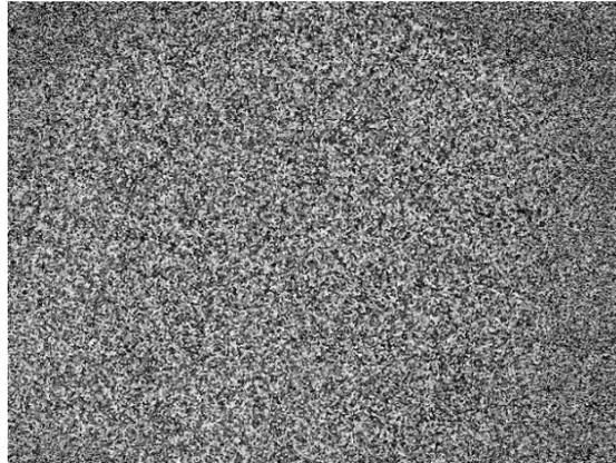
Figura 3.3 – Granulado óptico (*speckle*) resultante da iluminação com luz coerente de um objeto rugoso.
