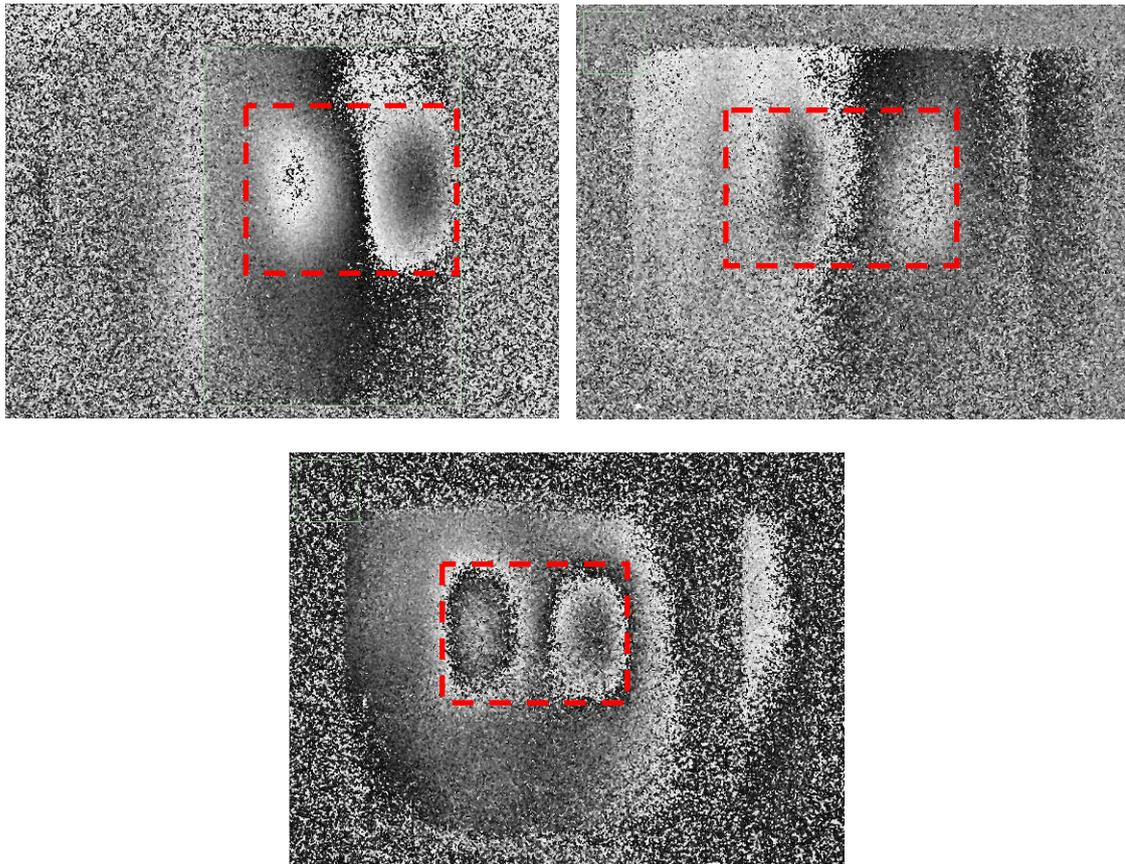
Figura 5.9 – Falha de adesão 2 no duto D. (a) Carregamento mecânico. (b) Carregamento térmico. (c) Carregamento a vácuo.
