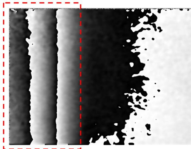
Figura 4.11 – Extremidade direita da falha de adesão do duto B.
