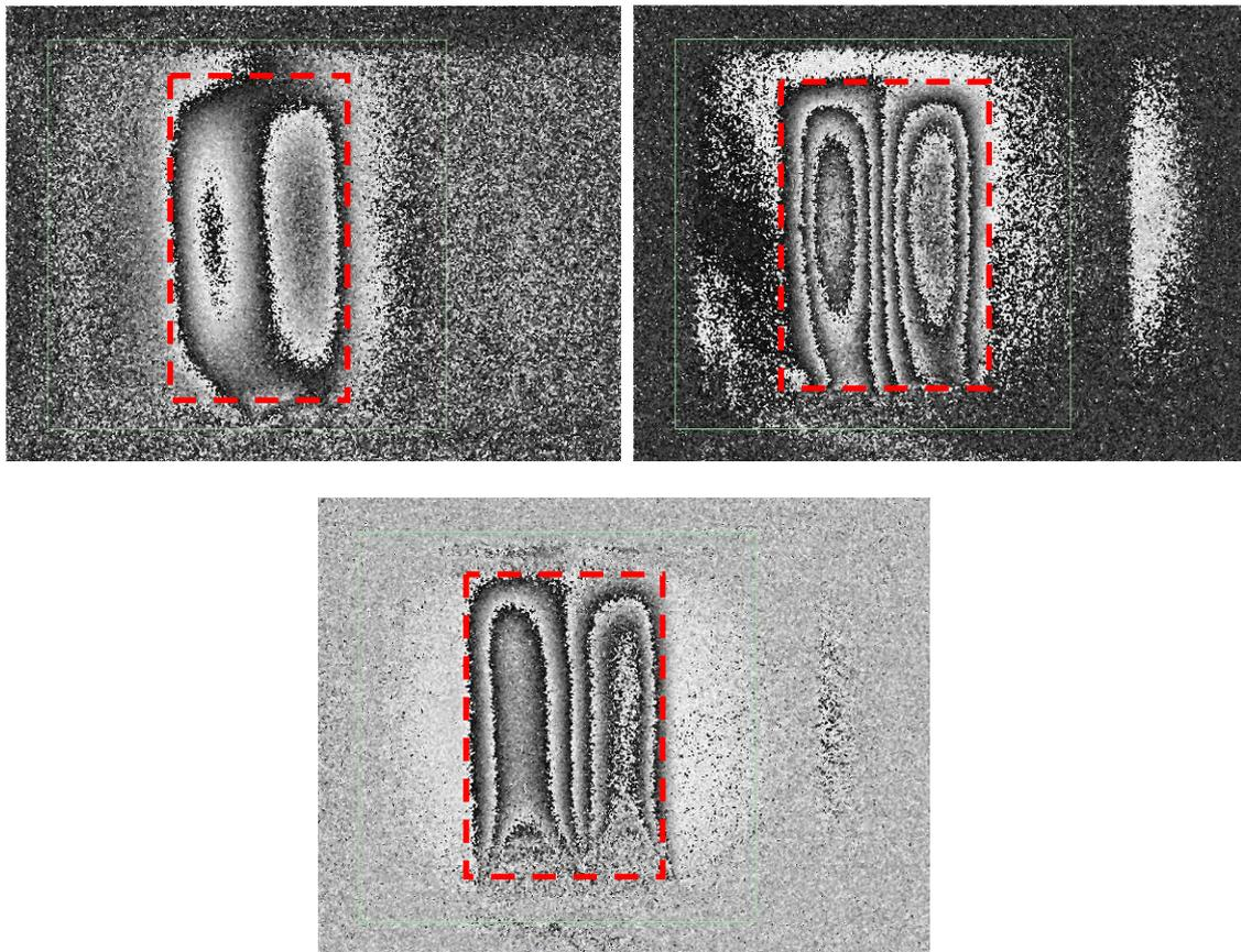
Figura 5.6 – Falha de adesão 1 no duto C. (a) Carregamento mecânico. (b) Carregamento térmico. (c) Carregamento a vácuo.
