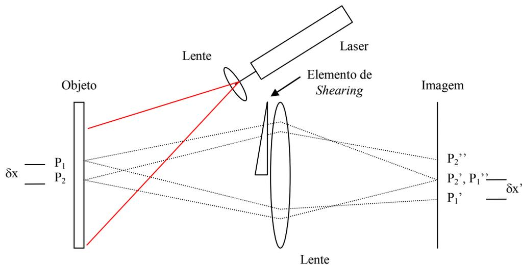
Figura 3.7 – Funcionamento da *shearography*. [1]
