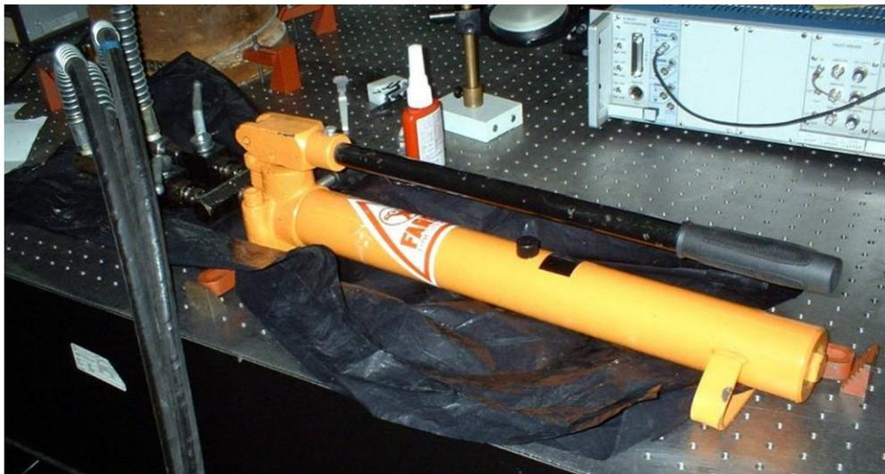
Figura 4.2 – Bomba hidráulica manual para aplicação de pressão.
