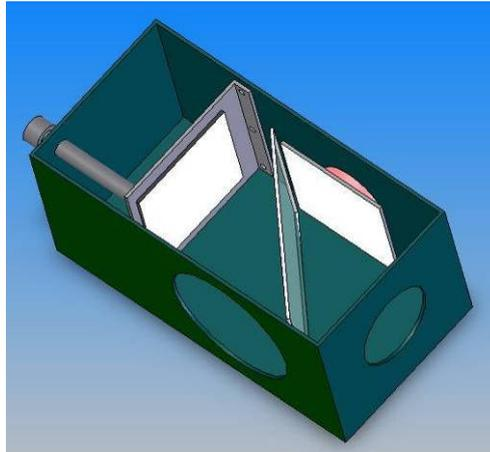
Figura 4.4 – Cabeçote de medição contendo o interferômetro de *Michelson* para geração do *shearing*.
