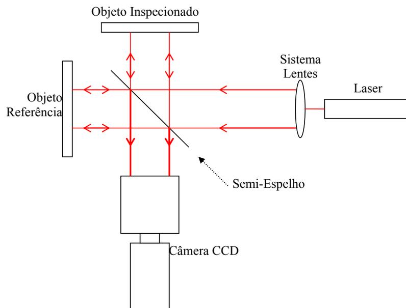
Figura 3.5 – Esquema básico de holografia eletrônica com iluminação simples.
