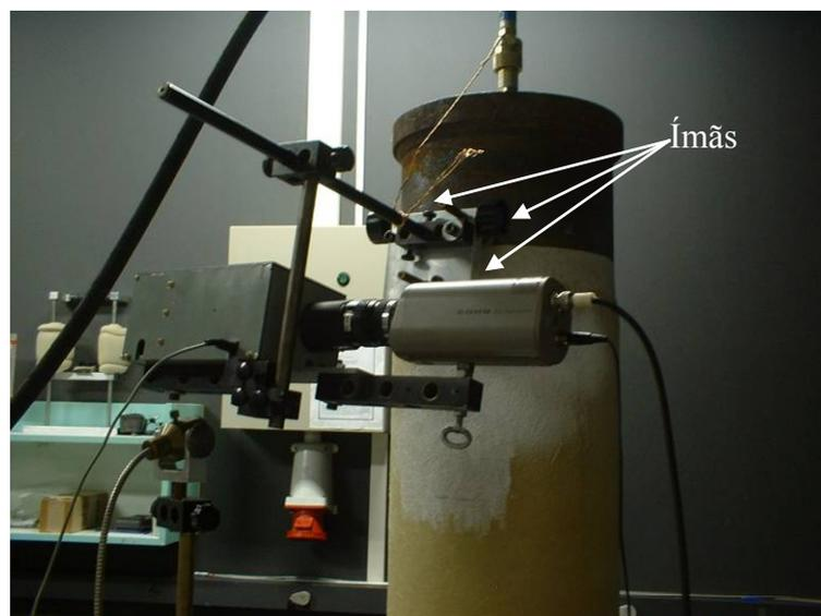
Figura 4.5 – Fixação do cabeçote de medição ao duto.
