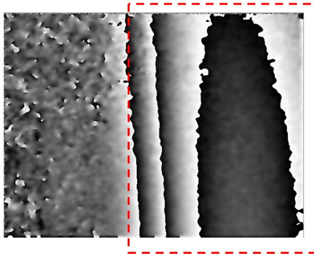
Figura 4.12 – Extremidade esquerda da falha de adesão no duto B.
