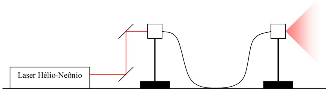
Figura 4.3 – Sistema de iluminação utilizando fibra óptica.
