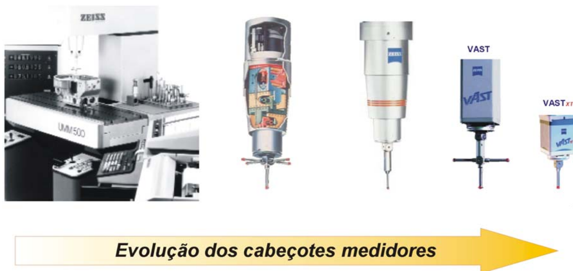
Figura 29: Evolução dos cabeçotes medidores analógicos ativos (adaptado de [47] e [48]).
