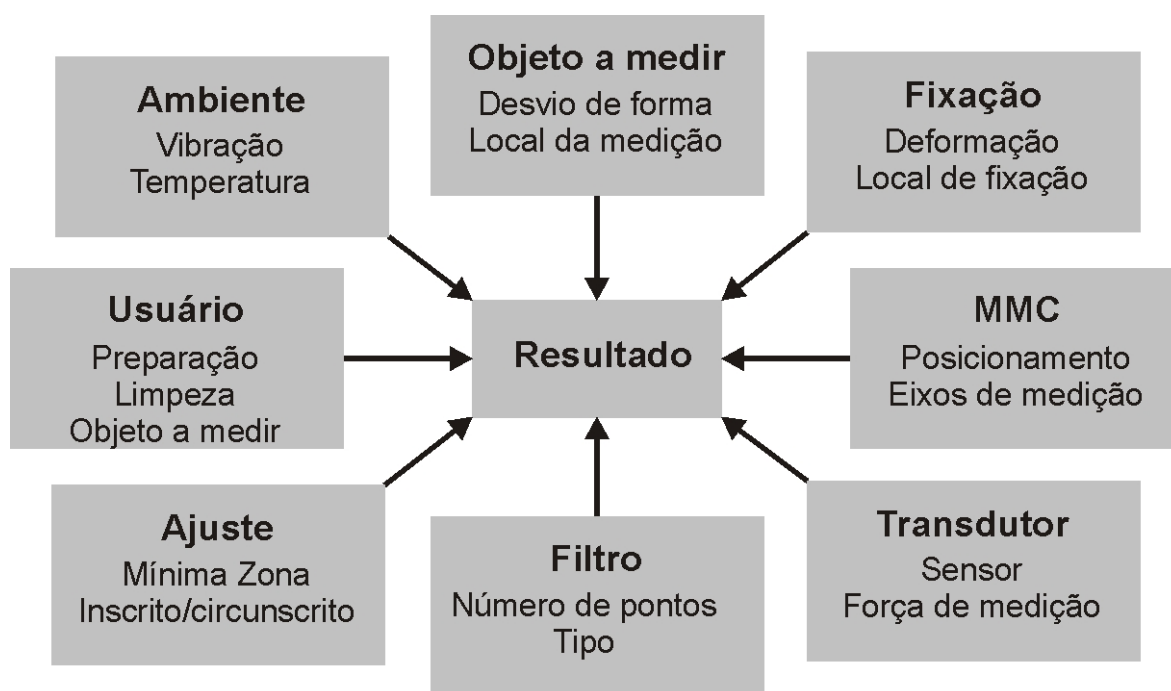
Figura 6: Influências no resultado da medição de forma (adaptado de [6]).
