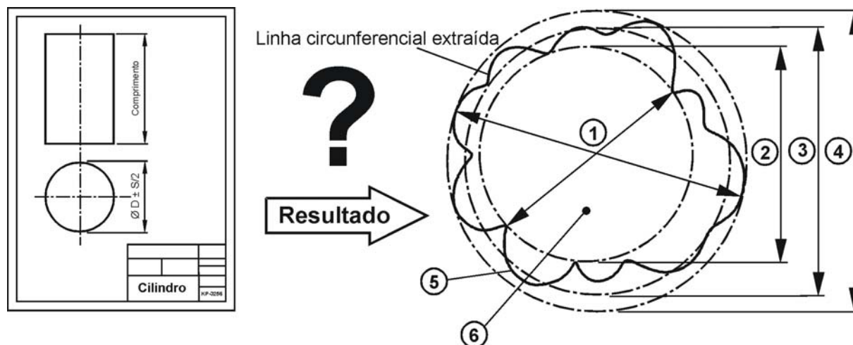
Figura 2: O conflito no entendimento da especificação de diâmetro, ocasionado pelo pensamento baseado em geometrias perfeitas (adaptado de [1]).
