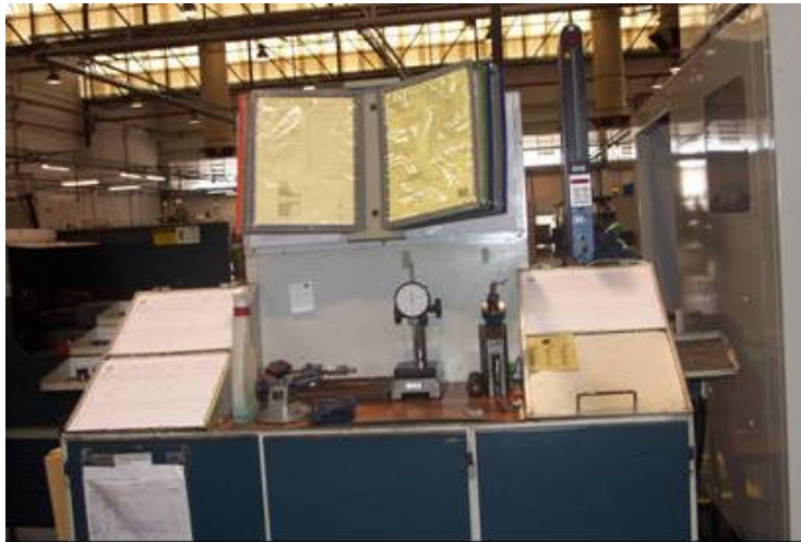
Figura 4.3 – Base metrológica em uma célula de trabalho
