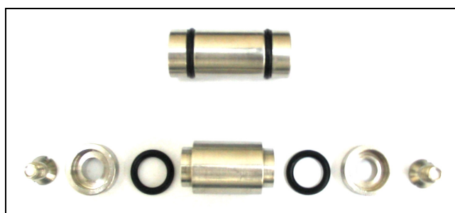
Figura A3 – Pistão utilizado na célula de equilíbrio.
