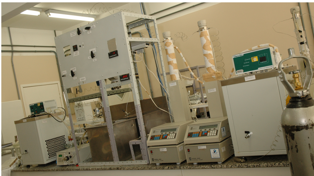
Figura 3.9 – Vista geral da unidade de precipitação.
