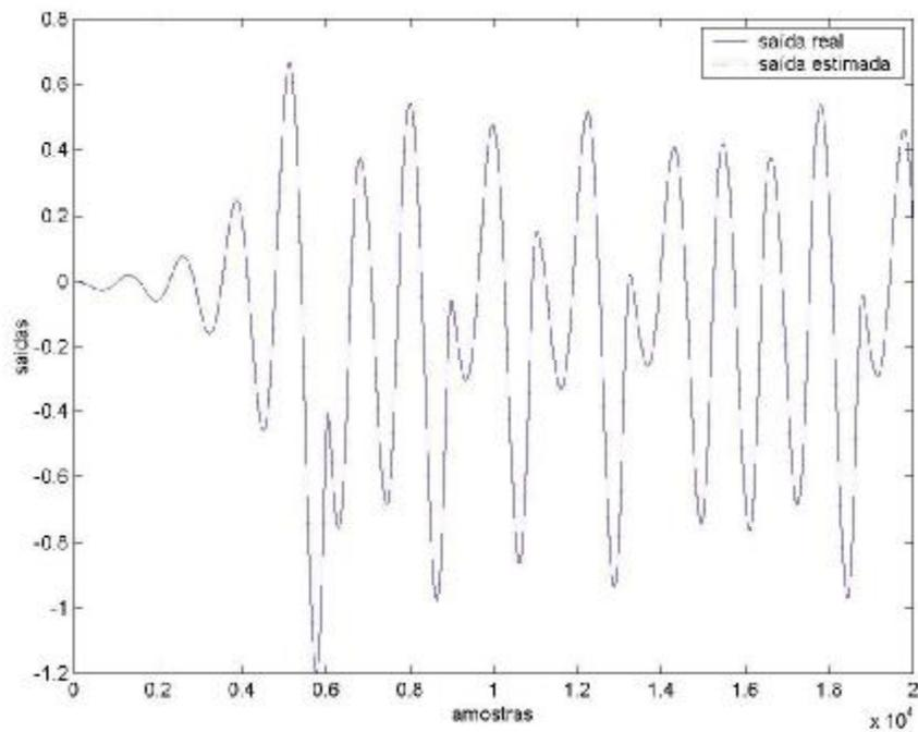
Figura 7.26. Saída do melhor resultado para identificação da coordenada y do sistema de Rössler com agrupamento  $k$ -médias e otimização pela pseudo-inversa (simulação 5).
