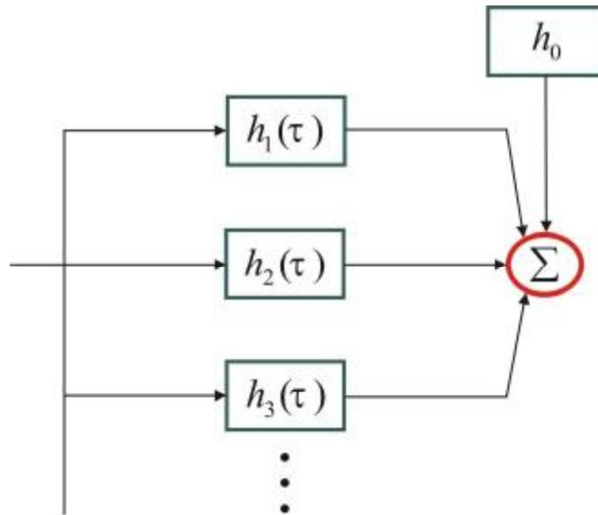
Figura 3.3. Representação gráfica da série de Volterra.
