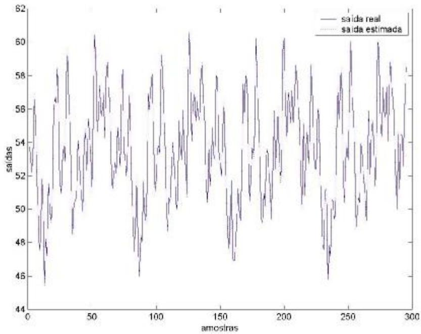
Figura 7.48. Saída do melhor resultado para identificação da fornalha de Box e Jenkins com agrupamento GG e otimização pela pseudo-inversa (simulação 4).
