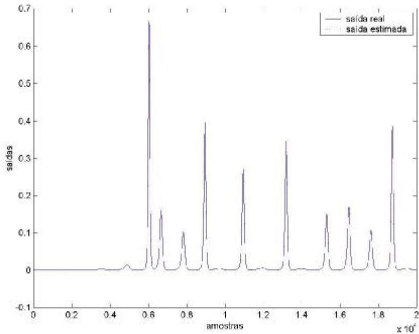
Figura 7.40. Saída do melhor resultado para identificação da coordenada  $z$  do sistema de Rössler com agrupamento GG e otimização pela pseudo-inversa (simulação 1).
