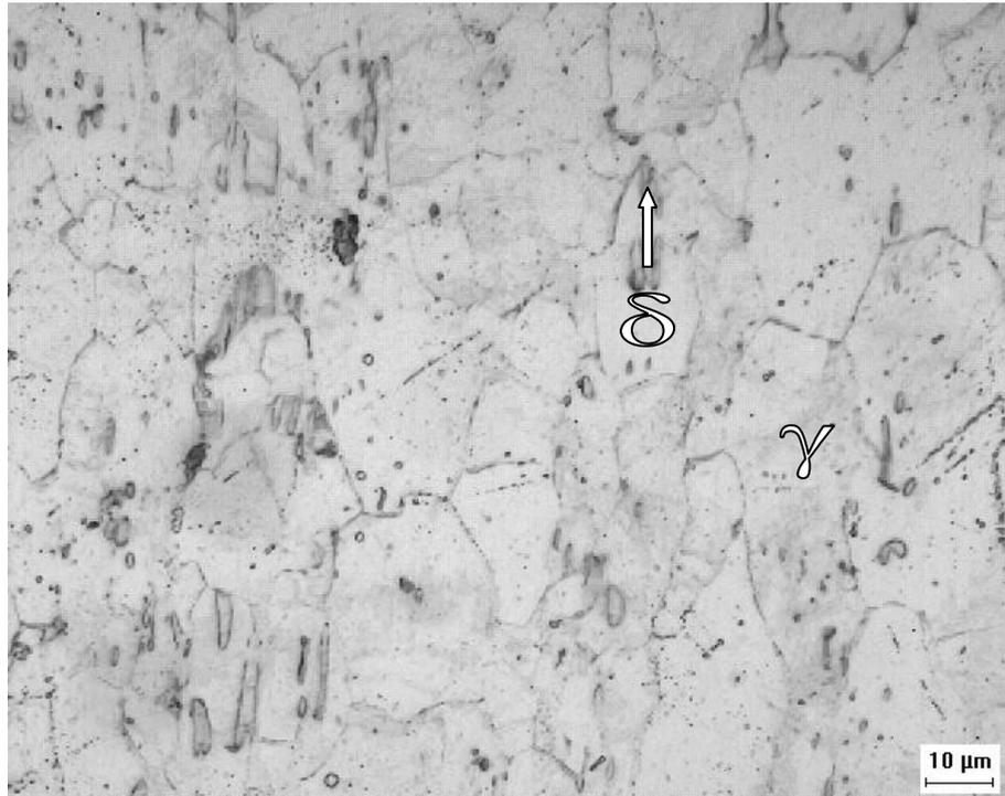
FIGURA 4.29 – Detalhamento em aumento de 1000 X da região mostrada na Figura 4.28 (Reagente de Villela).
