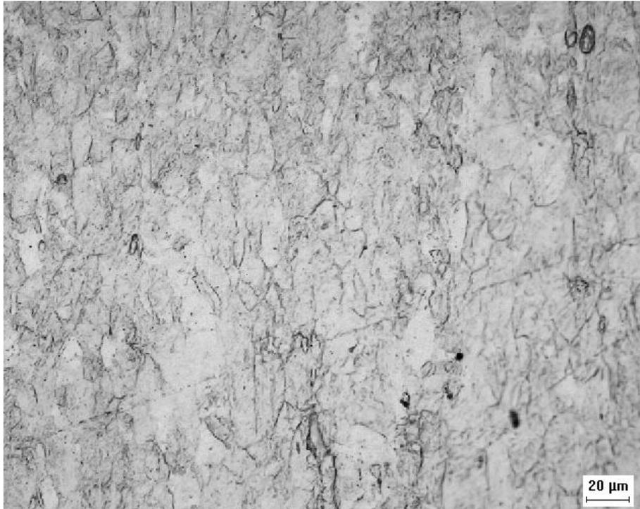
FIGURA 4.9 – Micrografia da amostra A2 em MO e em aumento de 500 X mostrando aspecto dos grãos austeníticos (Ataque eletrolítico).
