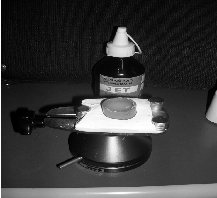
Figura 3 – Inserção da resina acrílica autopolimerizável no tubo de PVC realizada durante a confecção dos corpos-de-prova
