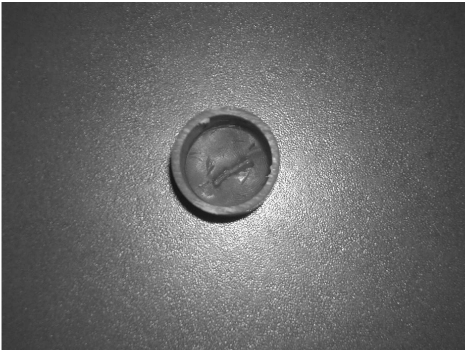
Figura 2 – Posicionamento da cera 07 numa das extremidades do tubo de PVC, para confecção dos corpos-de-prova
