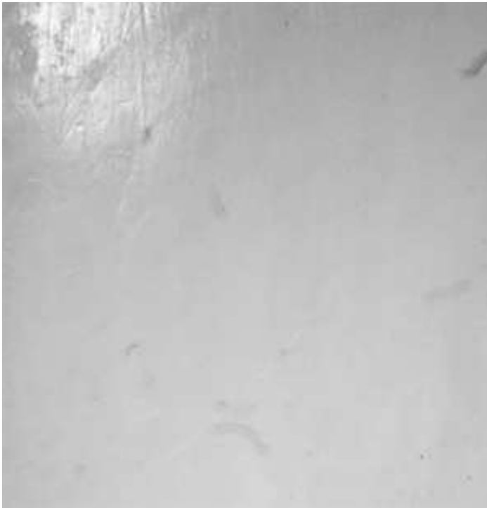
Figura 15 - Fratura adesiva no corpo-de-prova 2 que foi colado com o Sistema adesivo autocondicionante (AdheSE Single Bottle (IVOCLAR-VIVADENT) + Salivan® + lavagem + secagem (ar) + Resina Z-100 (3M) cor B-3
