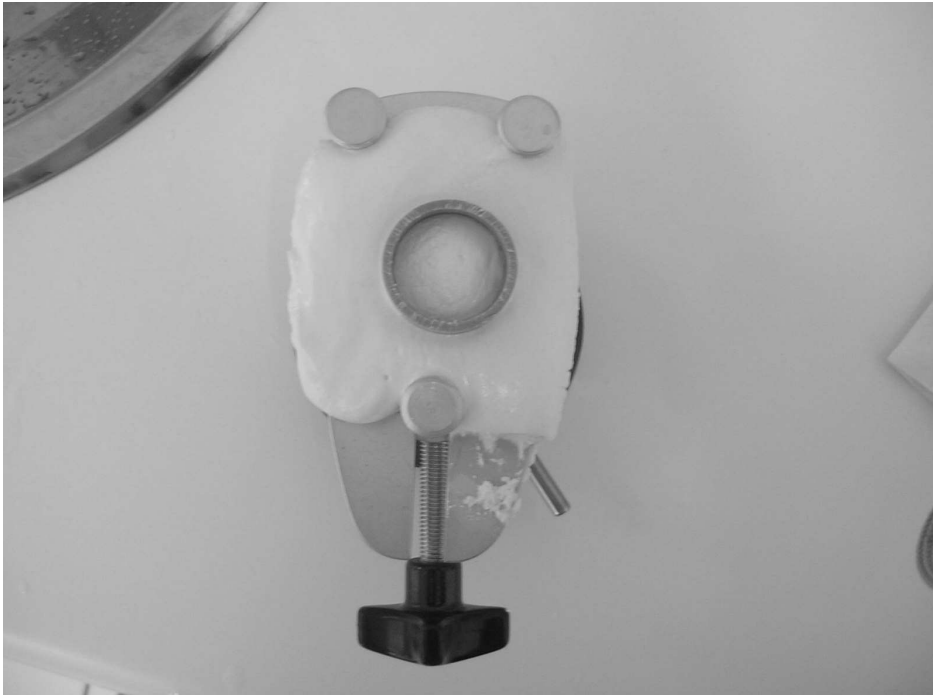
Figura 1 – Confeção da base de gesso onde foram posicionados os tubos de PVC, para confecção dos corpos-de-prova
