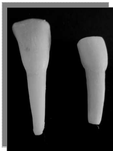
Figura 7 - Vista vestibular do dente bovino hígado e padronizado em 25 mm
