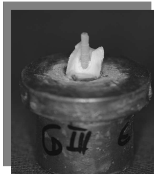
Figura 58 – Corpo-de-prova G 3 logo após a fratura
