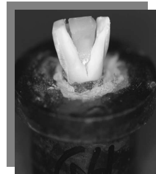
Figura 59 – Corpo-de -prova G 4 logo após a fratura
