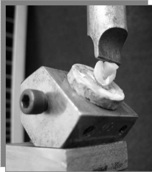
Figura 54 – Corpo-de-prova logo após a fratura
