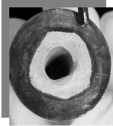
Figura 32 - Alvéolo artificial na resina epóxica
