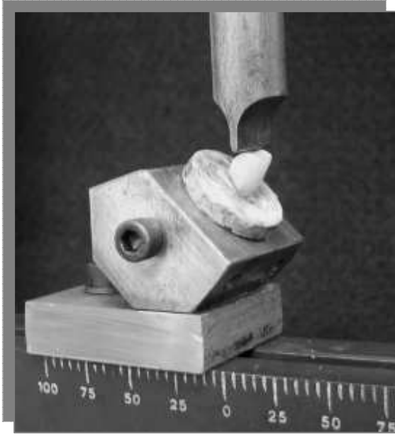
Figura 52 – Corpo-de-prova posicionado na máquina de ensaios recebendo a carga, vista frontal.
