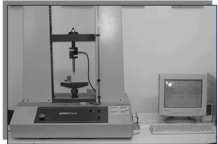
Figura 47 - Máquina Universal de Ensaios Pantec Panambra
