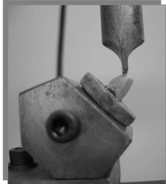
Figura 53 – Corpo-de-prova posicionado na máquina de ensaios, recebendo a carga e prestes a falhar
