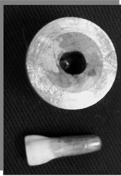
Figura 34 - Alvéolo artificial e raiz dentária com adesivo para poliéter
