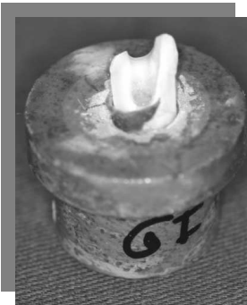
Figura 56 – Corpo-de-prova G 1 logo após a fratura
