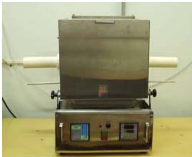
Figura 3.2 - Forno utilizado na sinterização das amostras.
