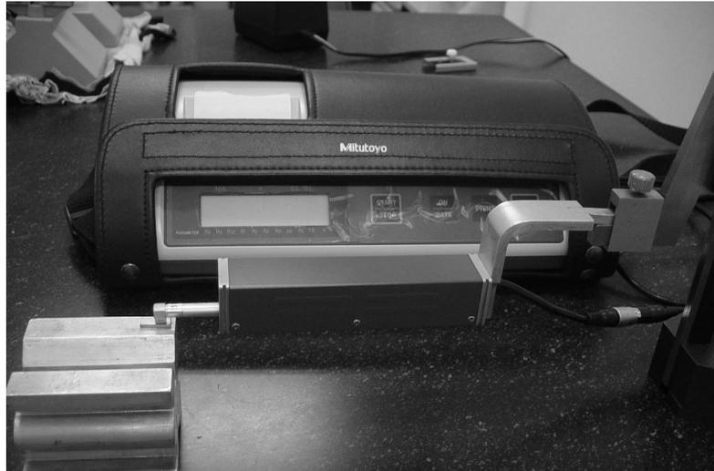
Figura 11- Rugosímetro utilizado para análise da superfície dos corpos-de-prova
