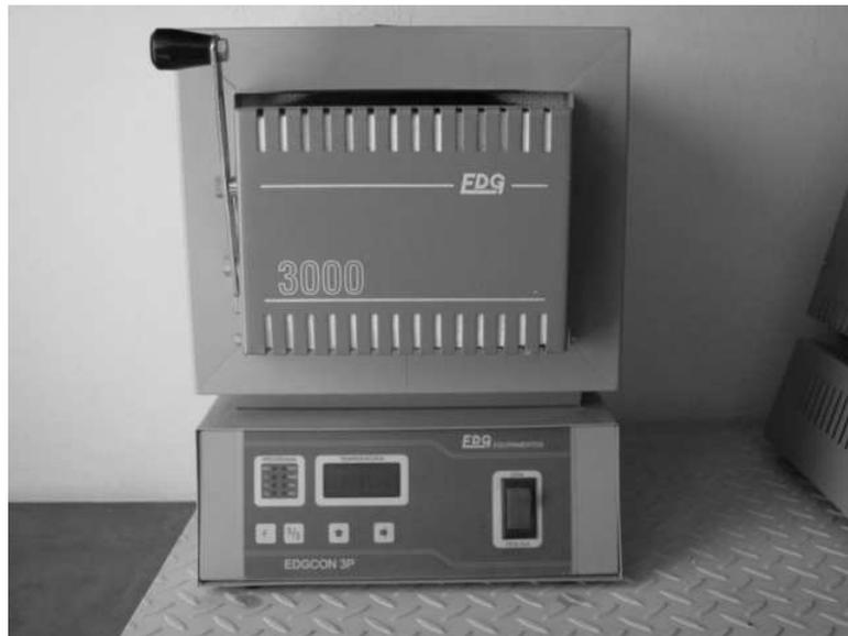
Figura 3a - Forno utilizado para evaporação do acrílico e aquecimento do revestimento
