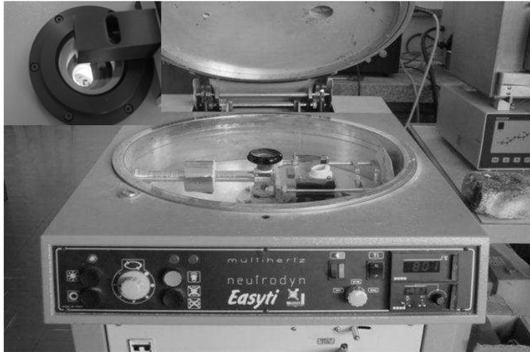
Figura 4 - Equipamento utilizado para fundição por centrifugação: Forno Easyti
