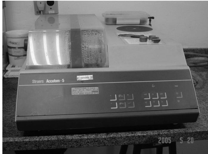
Figura 5 – Máquina utilizada para o corte das amostras
