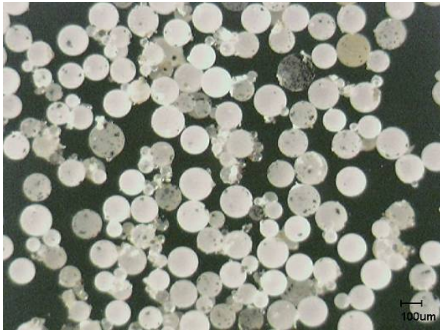
Figura 57 – Micrografia de microscopia ótica do copolímero de STY/DVB/MMA preparado com HEC e 2% w/v de ferro – FP23
