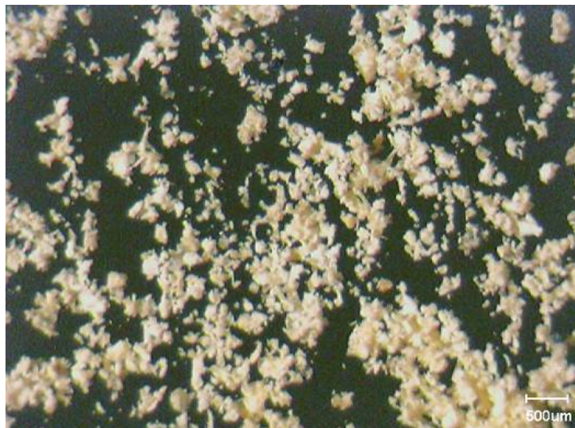
Figura 35 - Micrografia de microscopia ótica de copolímero de STY/DVB/MMA preparado com 20% de DVB, Diluição de 50% e 10% de MMA – FP13
