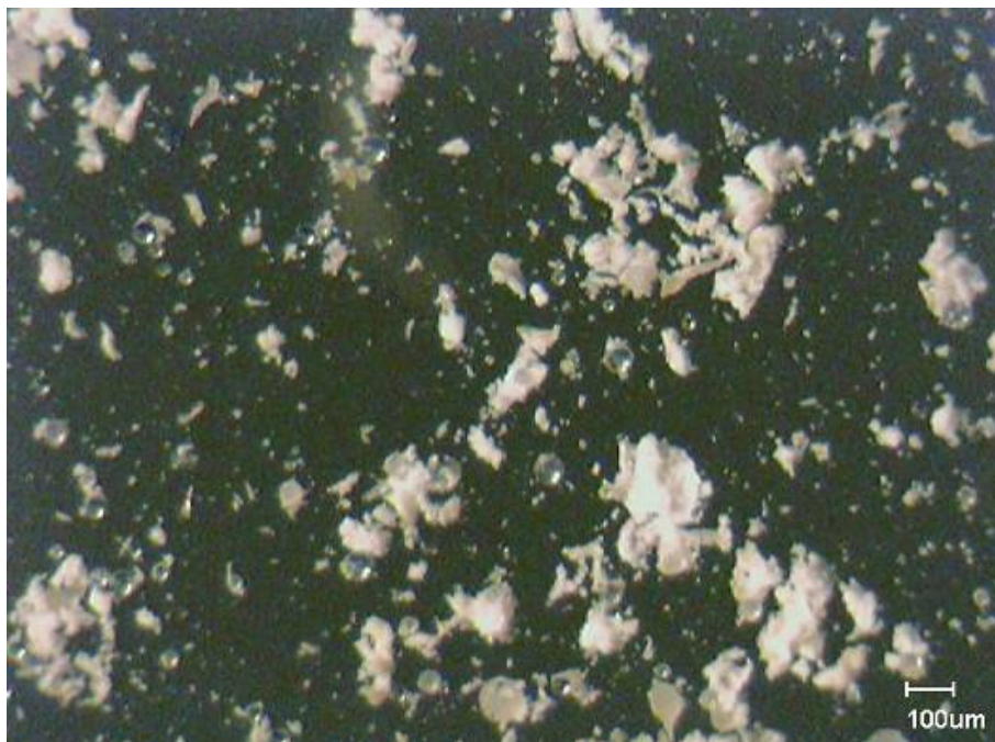
Figura 58 – Micrografia de microscopia ótica de copolímero de STY/DVB/MMA preparado sem HEC e 2%w/v de ferro – FP22
