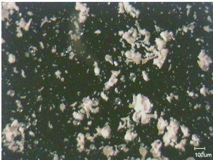
Figura 61 – Micrografia de microscopia ótica do copolímero de STY/DVB/MMA preparado com 2% p/v de ferro – FP22
