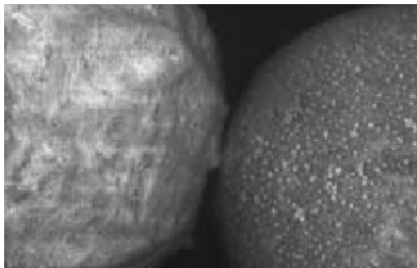
Figura 3 – Micrografia eletrônica de varredura de 02 pérolas distintas de um mesmo copolímero apresentando diferente incorporação de material magnético (Santa Maria et al., 2003)
