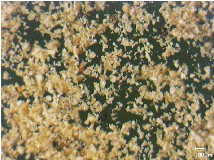
Figura 19 – Micrografia de microscopia ótica de copolímero de STY/DVB/MMA preparado com 10% de DVB e sem MMA - FP04
