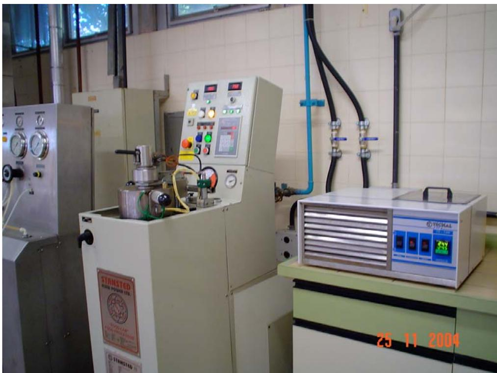
**Figura 6:** Equipamento de Alta Pressão Hidrostática.
