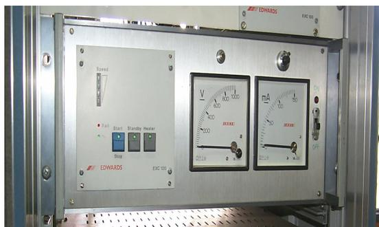
Figura 4.2 - Foto da fonte de tensão da lâmpada de He instalada juntamente com a unidade de controle da bomba turbomolecular.
