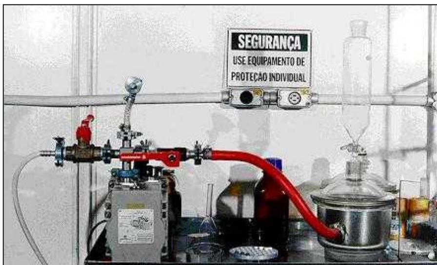
**Figura 18 – Sistema para impregnação de pastilha com xilol.**
