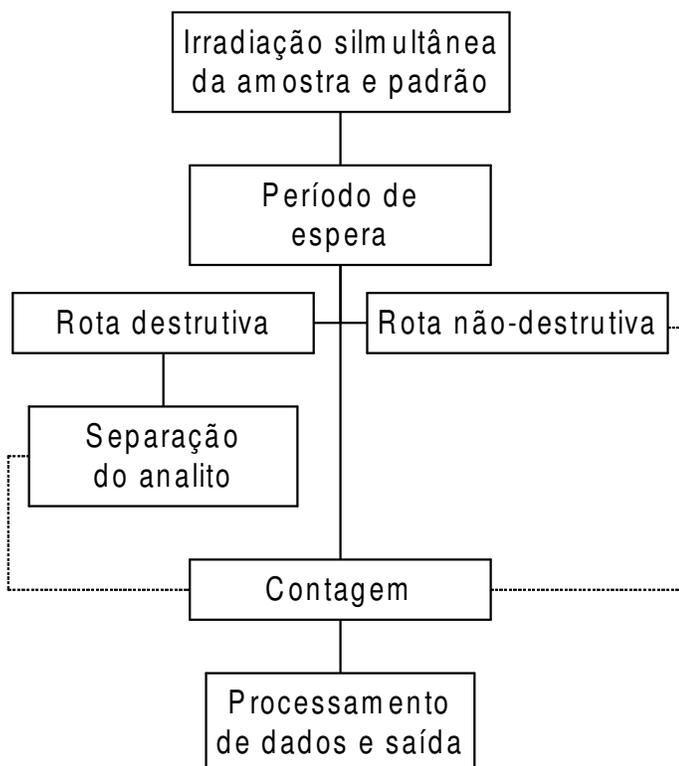
**Figura 5 - Diagrama para os dois tipos de rotas usadas em Ativação Neutrônica**
