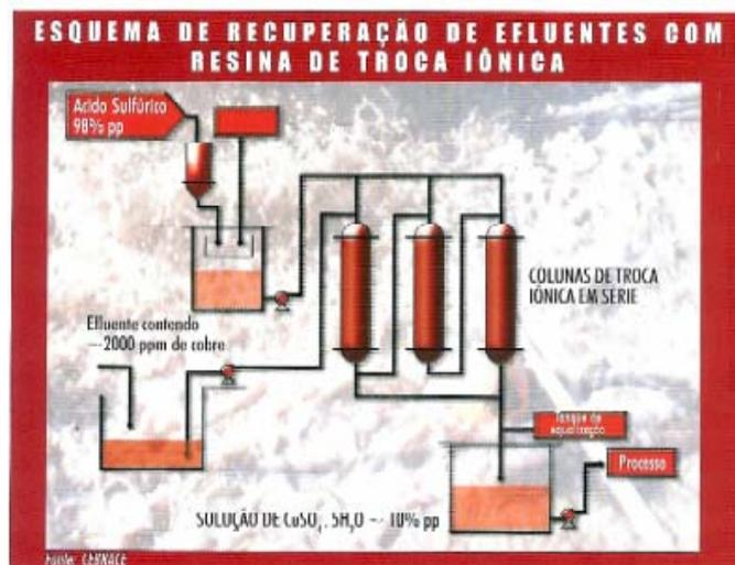
Figura 13 – Esquema de recuperação de efluentes com resina de troca iônica (Furtado, 2002)
