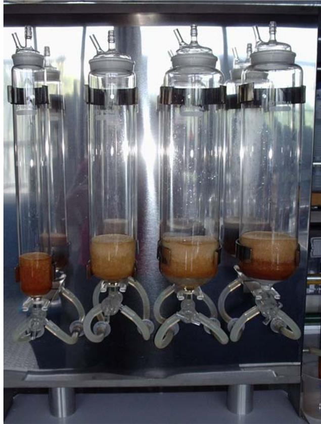
Figura 15 - Colunas de troca iônica – Recuperador de resinas
