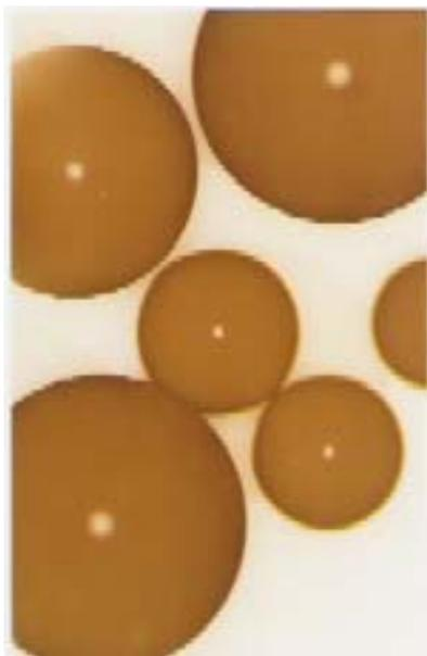
Figura 21 - Microscopia óptica típica de uma resina macroporosa (Amberlyst 15 wet) – aumento de 50 vezes
