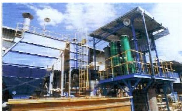
Figura 14 – Unidade de recuperação de cobre por resinas de troca iônica – CEBRACE (Furtado,2002)
