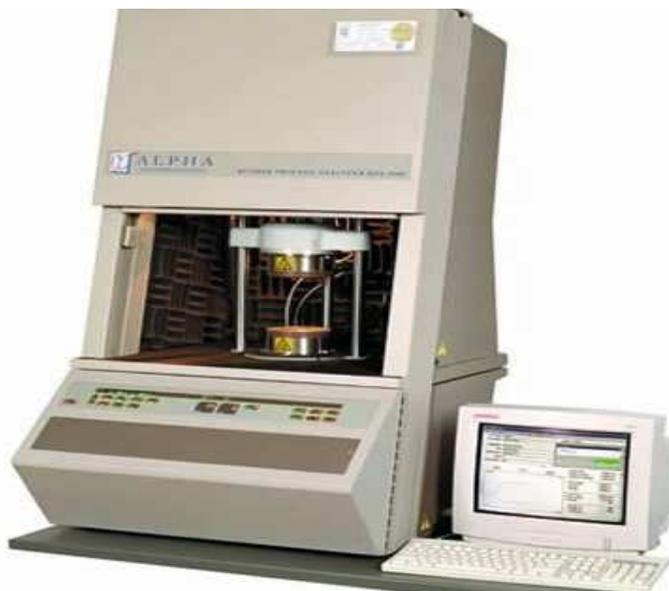
Figura 23 – Vista do equipamento RPA 2000 acoplado ao computador (Manual do equipamento, 2003)
