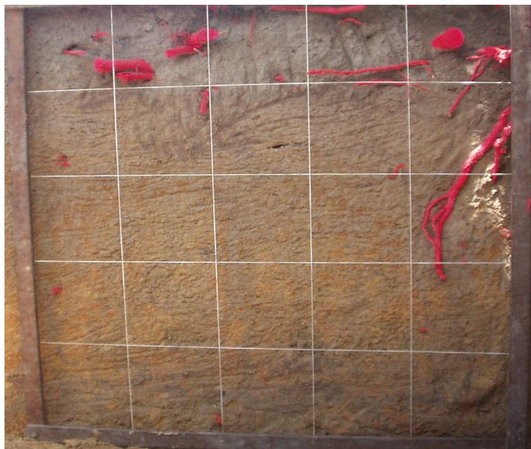
Figura 2.1. Raízes pintadas e distribuídas por quadrículas de 0,04 m<sup>2</sup> em quadro de 1 m<sup>2</sup> para obtenção de imagens no campo e quantificação em laboratório.
