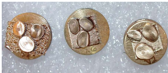
Figura 19 - Amostras fixadas em stubs por meio de fita adesiva de Carbono, após o processo de metalização com Ouro.
