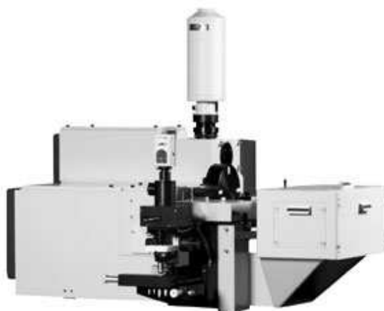
Figura 8: Espectrômetro Yvon Jobin modelo T64000 equipado com um detector CCD resfriado com nitrogênio líquido e um microscópio confocal Olympus modelo BX40.
