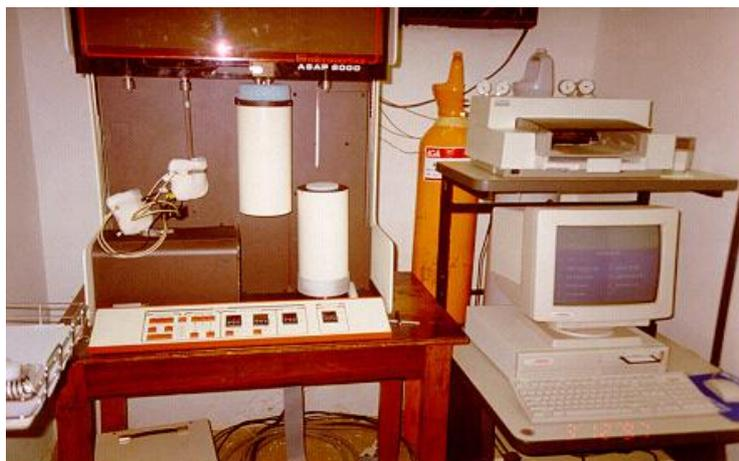
**Figura 3. 1.** Microporosímetro ASAP 2010
