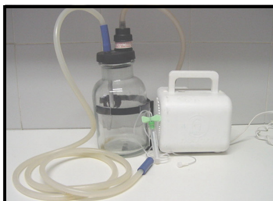
Figura 4.2- Equipamento para a realização de coleta salivar (dispositivo e bomba à vácuo)
