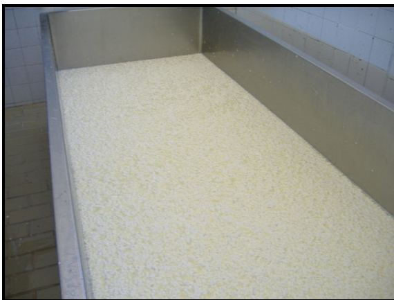
Figuras 2 e 3: Tanque de dessoragem e coleta do soro de queijo Minas Frescal realizada no Laticínio.
