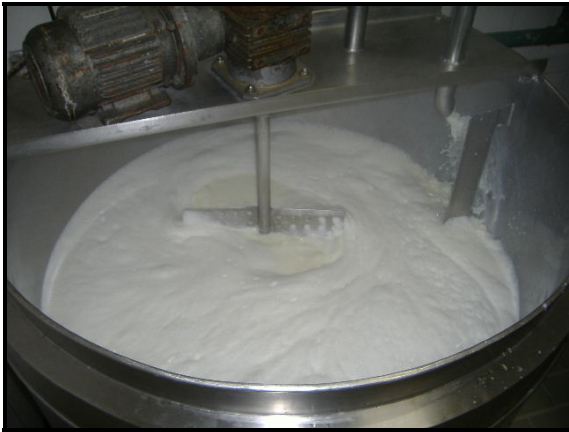
Figuras 4 e 5: Enchimento da fermentadeira com a mistura de soro e leite e fermento láctico utilizado na fabricação da bebida láctea fermentada.
