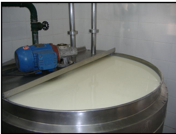
Figuras 6 e 7: Quebra da coalhada ao atingir 50°D e produto pronto para o envase após adição de polpa, corante, aroma e ferro.
