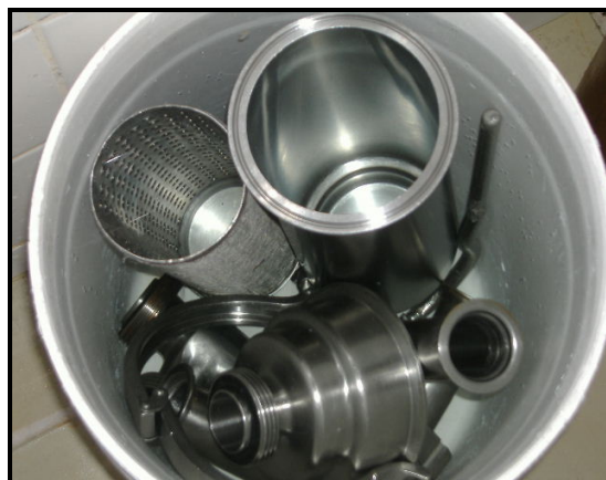
Figura 8 e 9: Desarticulação de PCCs realizada durante higienização e imersão das peças em solução com hipoclorito de sódio.
