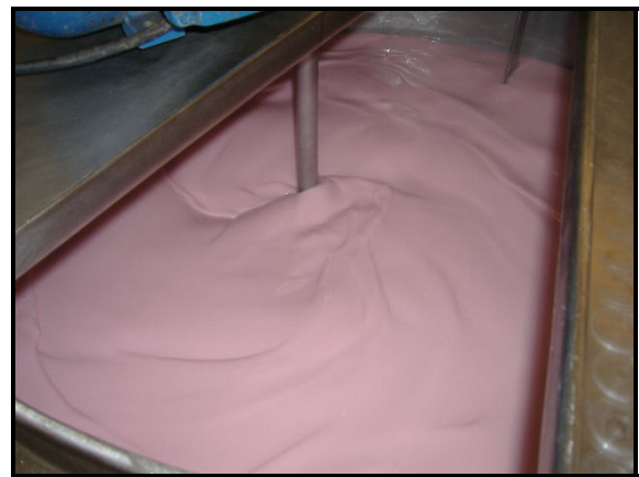
Figuras 6 e 7: Quebra da coalhada ao atingir 50°D e produto pronto para o envase após adição de polpa, corante, aroma e ferro.
