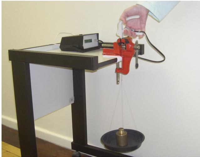
Figura 6: Alicates posicionado no torno de bancada e aferição com o peso.
