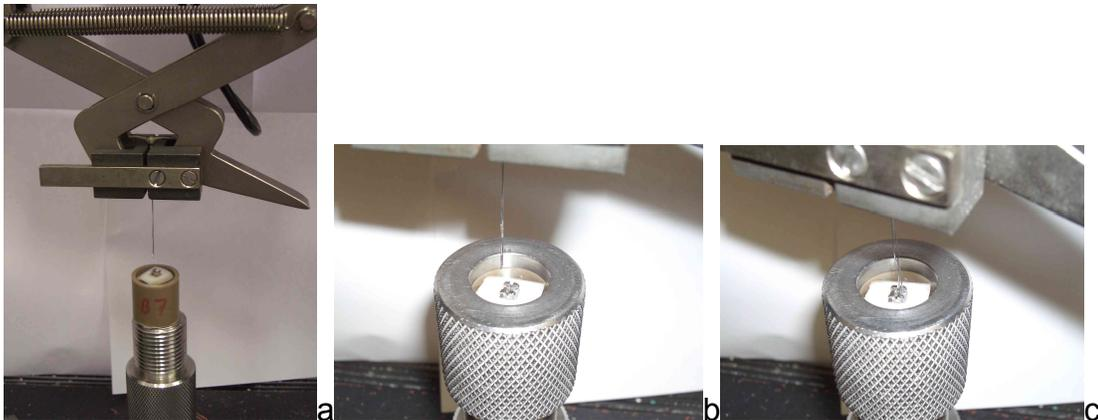
Figura 12. Descolagem dos bráquetes por tração, pela máquina de ensaio universal.
