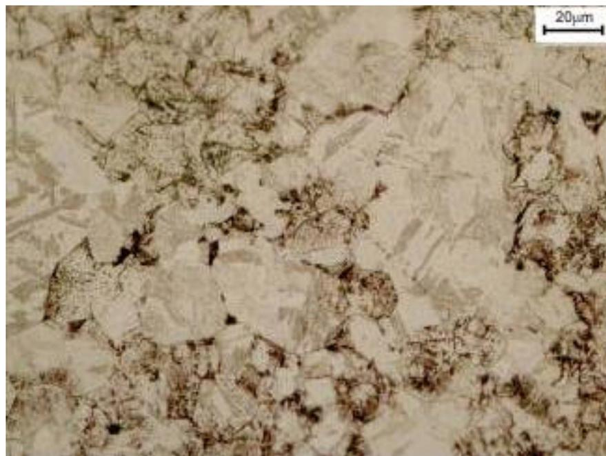
FIG. 4-25 - Microestruturas martensíticas revenida encontradas no MB (ataque com Kalling 2).
