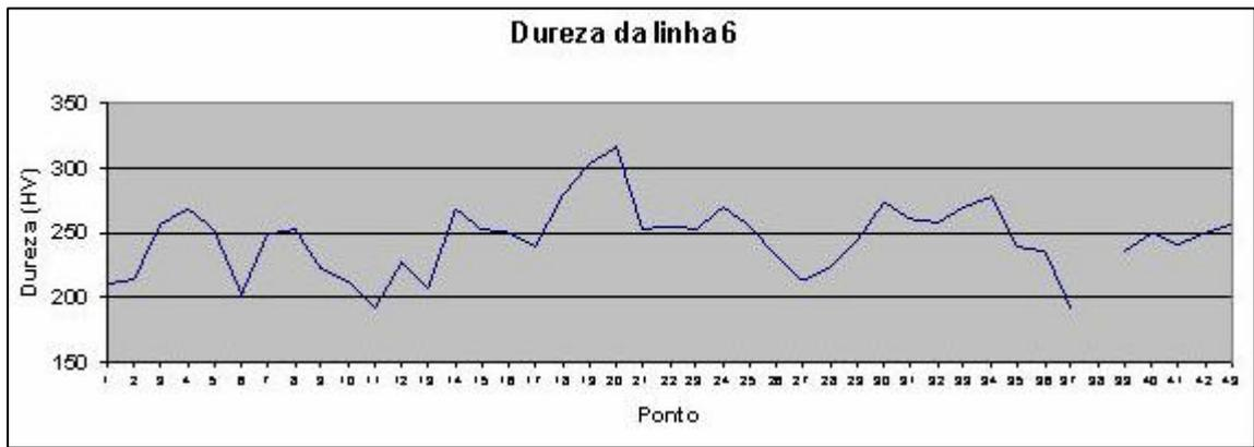
GRAF. 8.6 - Microdureza ao longo da linha L-6 em HV x ponto medido.
