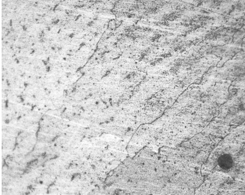
FIG. 4-20 - Microestrutura observada no passe P4 e P3 em região com características de uma matriz austenítica com presença de precipitados (ataque Kalling 2).
